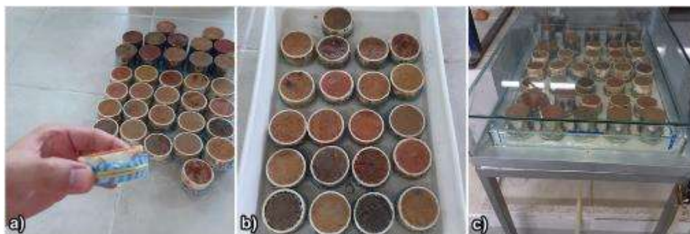
Figura 56 - Etapas do ensaio para determinação da sucção por meio da mesa de tensão: a) preparação da amostra com telas de náilon e elástico; b) processo de saturação do solo por capilaridade; c) Realização do ensaio com mesa de tensão coberta.
