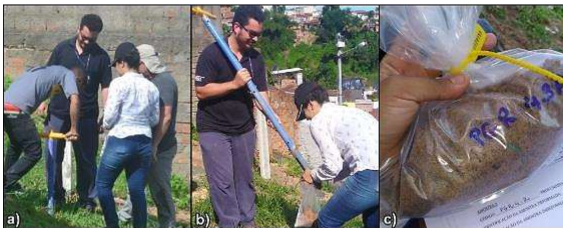
Figura 49 - Coleta de amostras deformadas por meio do trado no ponto P-8: a) processo de tradagem; b) coleta de solo; c) identificação das amostras.
