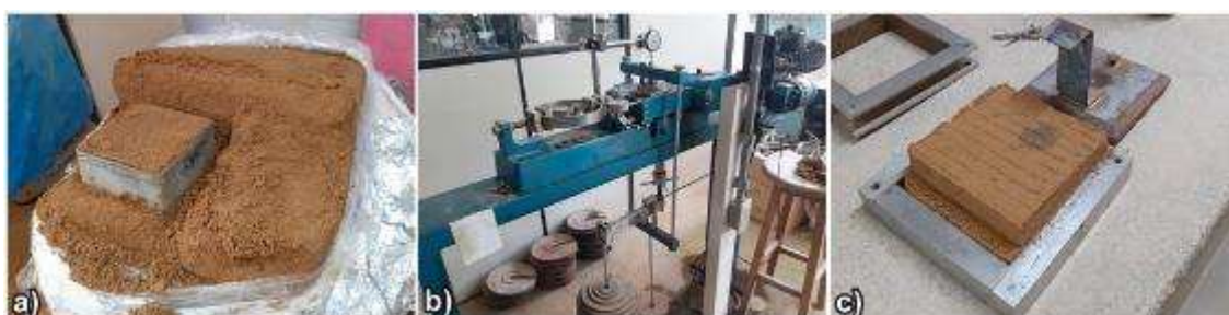
Figura 60 - Etapas de realização do ensaio de cisalhamento direto: a) moldagem do corpo de prova; b) realização do ensaio na prensa de cisalhamento; c) amostra cisalhada após o ensaio.
