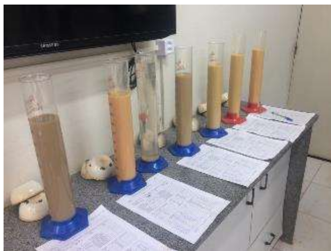
Figura 54 - Realização do ensaio de sedimentação com adição de defloculante nas amostras coletadas no ponto P-7.
