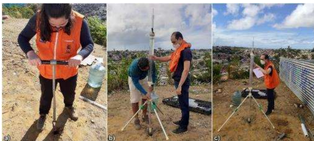
Figura 51 - Procedimento de instalação e realização do ensaio com o permeâmetro de Guelph: a) realização do furo com o trado, b) instalação do equipamento, c) realização das leituras durante o ensaio.
