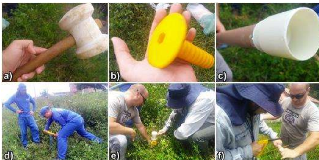
Figura 55 - Procedimento de coleta de amostra indeformada: a) Martelo de borracha; b) ponteira de borracha; c) Aparato utilizado para coleta do solo; d) Abertura do furo por meio do trado; e) Cravação da bucha por meio dos golpes do martelo; f) Processo de corte da amostra.
