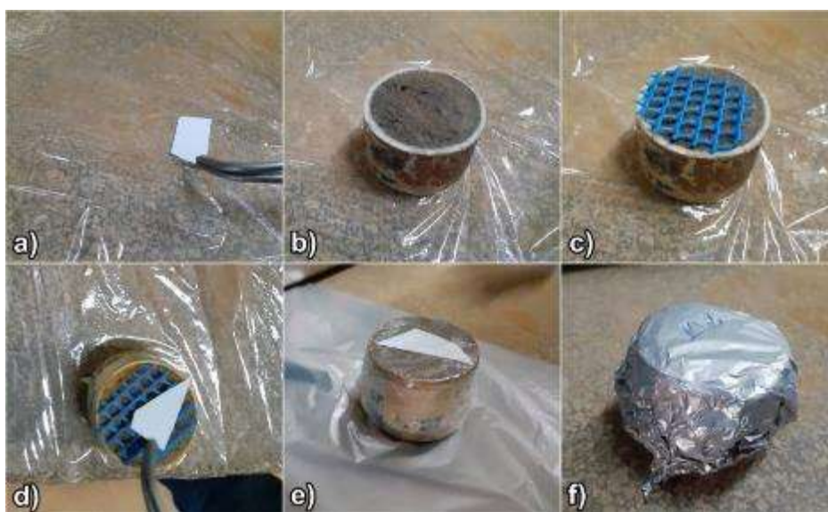
Figura 57 - Etapas para determinação da sucção mediante o emprego da técnica do papel filtro: a e b) determinação da sucção total (papel filtro em contato com solo); c e d) determinação da sucção mátrica (papel filtro sem contato com o solo); e) amostra embrulhada com filme de PVC; f) amostra embrulhada com papel alumínio.
