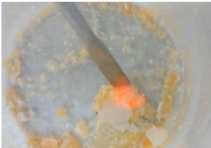
Figura 20 - Efeito da triboluminescência do complexo \text{Eu}(\text{TTA})(\text{BTFA})(\text{DBM})(\text{TPPO})_2 via One Pot .
