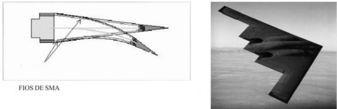
Figura 20 – Fios de LMF aplicados em asas de avião.
