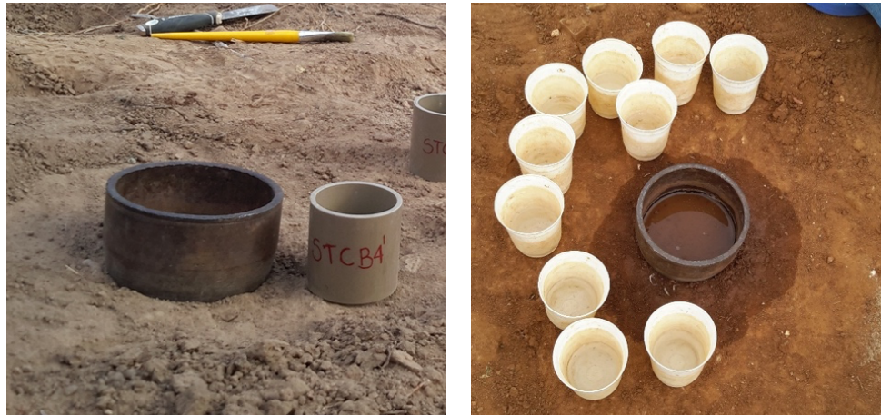
Figura 3 - Ensaio de infiltração in situ utilizando infiltrômetro de anel simples de 12,60 cm de diâmetro e volumes fixos de 100 mL de água.
