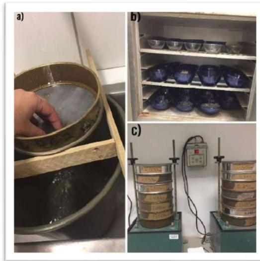
Fonte: o autor (2018). a) Peneiramento úmido b) Secagem na estufa
