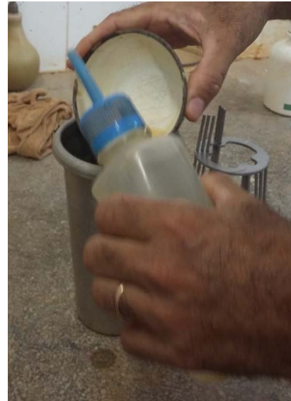
Figura 10 - Limpeza com água destilada para evitar perda de material para o misturador
