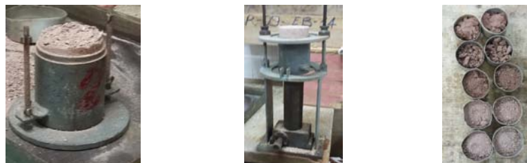
Figura 15 - Execução do ensaio proctor
