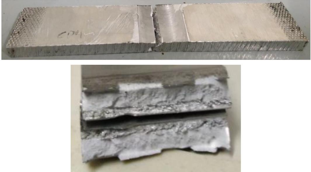
O corpo de prova CP4, pertencente à liga 2017 de alumínio e retirado de um trecho de junta com a presença de vazios internos/porosidade, também apresentou uma fratura nucleada pelo defeito interno apresentado, estendendo-se até a superfície superior da amostra, tal como é observado acima. A curva tensão x deformação e a resistência máxima suportada pelo corpo de prova é dado abaixo:
