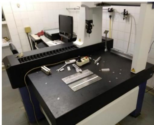
O procedimento experimental consistiu em marcar a coordenada “z” (altura) de diversos pontos sob a área do conjunto soldado por FSW, em relação ao plano base da máquina, calculando posteriormente a maior amplitude medida como o “índice de planeza” da peça.
