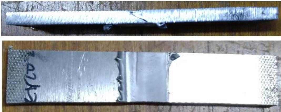
O corpo de prova CP1, pertencente à liga 5083 de alumínio e retirado de uma junta com a presença de vazios internos/porosidade, apresentou uma fratura nucleada pelo defeito interno apresentado, estendendo-se até a superfície superior da amostra, tal como é observado acima. A curva tensão x deformação e a resistência máxima suportada pelo corpo de prova é dado abaixo:
