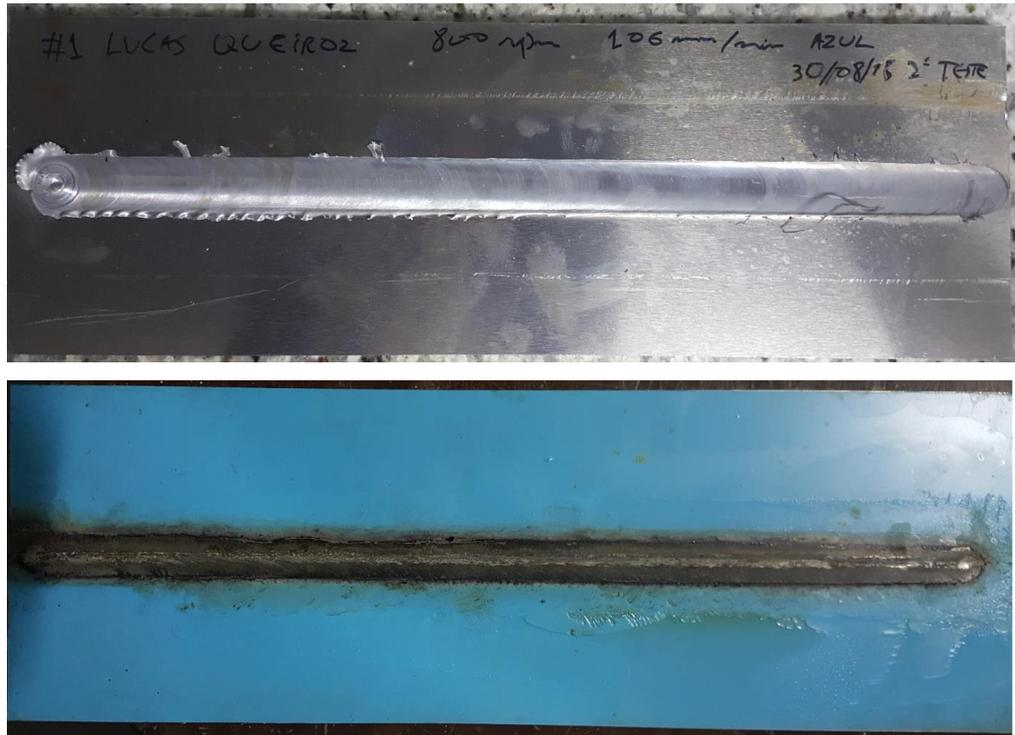
Figura 39. Junta "#2" soldada pelo método FSW
