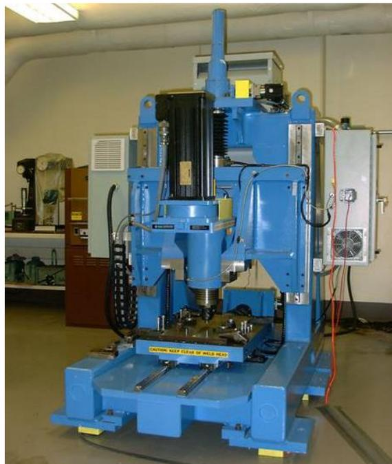
*Figura 11. Exemplo de maquinário robótico com diversos graus de liberdade para a execução de soldagens por fricção e mistura.*
