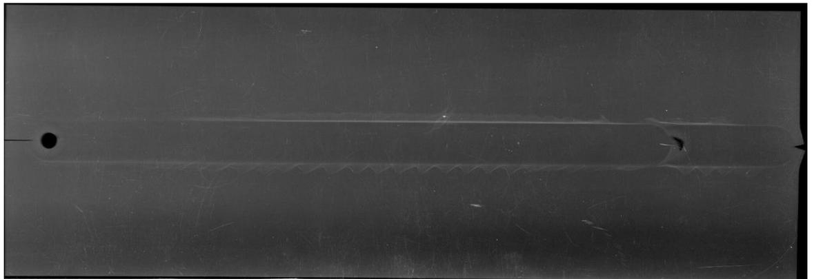
*Figura 50. Radiografia da junta “#6”, soldada pelo método FSW*
