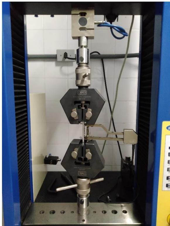
O procedimento experimental consistiu em realizar o ensaio de tração sob os corpos de prova CP1, CP4 e CP6, de acordo com a nomenclatura e o procedimento de obtenção destas amostras relatado no tópico anterior deste trabalho.
