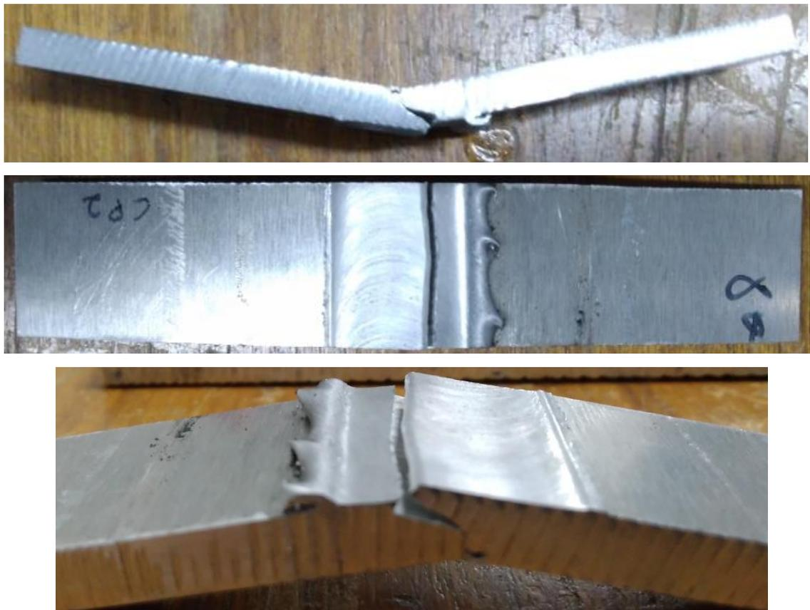
O corpo de prova CP2 – pertencente à liga 5083 de alumínio - apresentou angulação máxima de cerca de 20° antes da sua fissura, que ocorreu de maneira abrupta e “guiada” pelo vazio interno formado durante o processo de soldagem por fricção e mistura, tal como é percebido nas imagens acima. Desta forma, conclui-se
