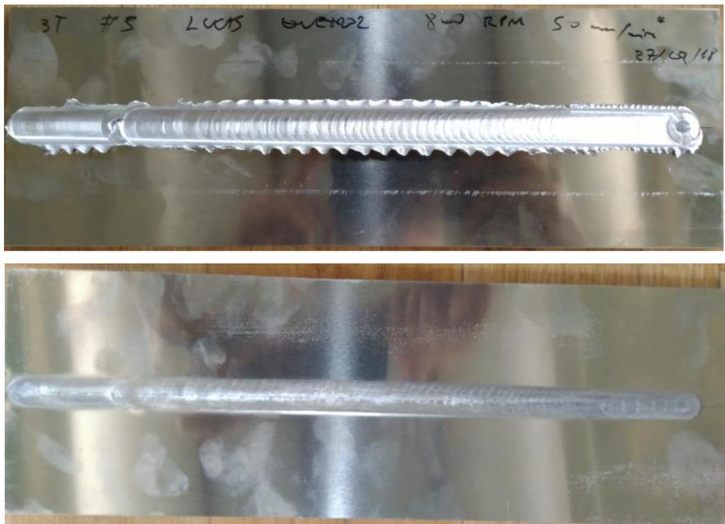
Figura 43. Junta "#6" soldada pelo método FSW
