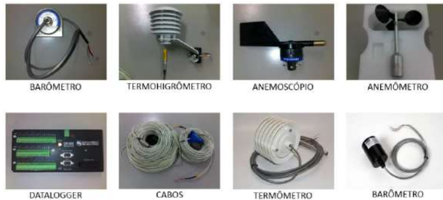
Figura 13 - Equipamentos de medições eólicas instalados na torre meteorológica.
