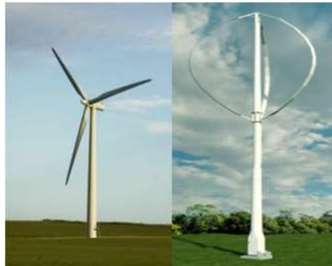
Figura 4 - Aerogerador de eixo horizontal (esquerda) e aerogerador de eixo vertical (direita).
