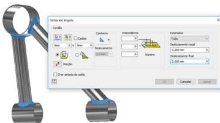
Figura 23: Soldagem dos tubos da bandeja superior no software
