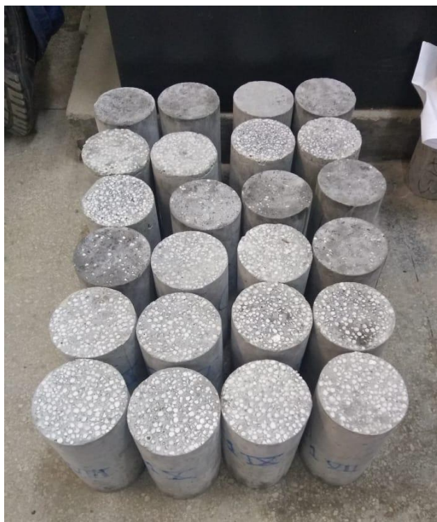
Figura 5 – Corpos de prova antes do ensaio de compressão
