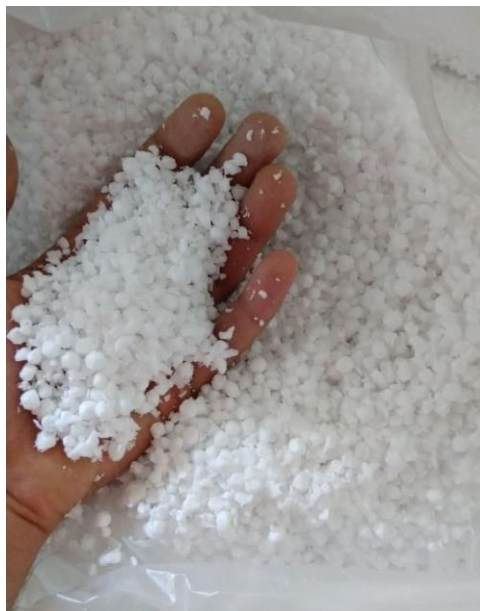
Figura 2 – EPS triturado utilizado no estudo.
