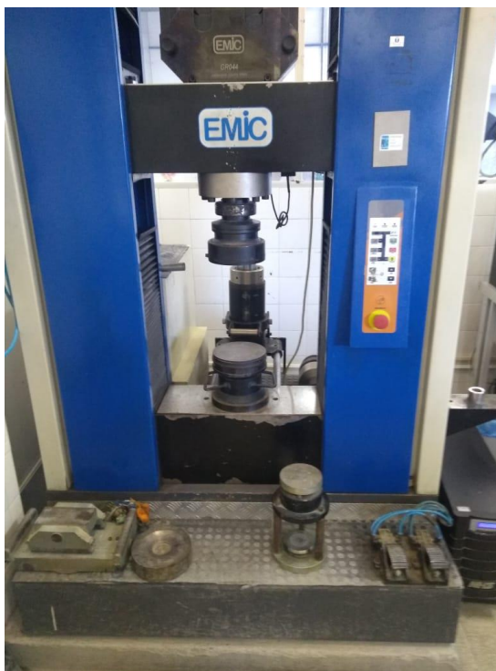
Figura 6 – Prensa utilizada para rompimento dos corpos de prova.
