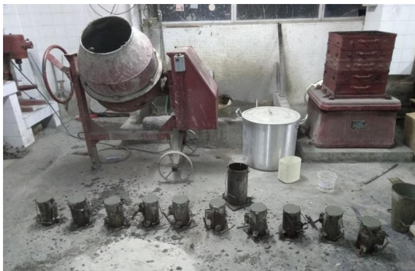
Figura 4– Betoneira utilizada e corpos de prova
