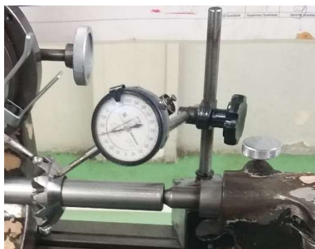
Figura 17: Método de medição do batimento da calota
