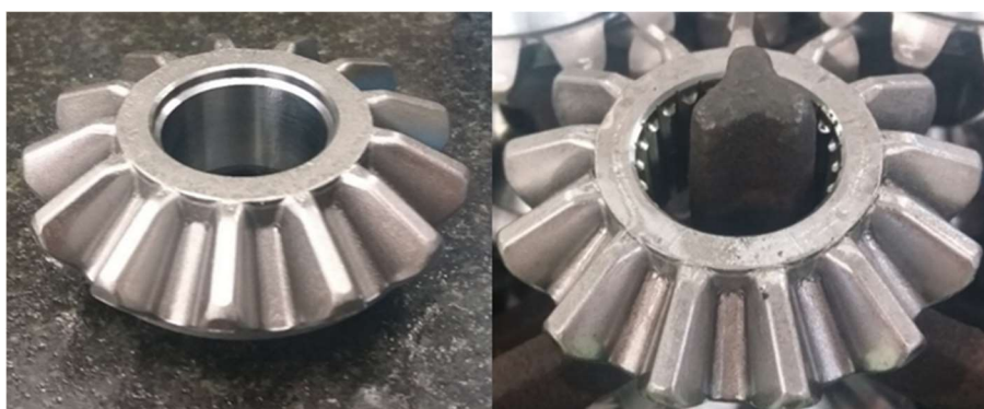
Figura 13: Engrenagem satélite do diferencial antes e após operação de brochamento de estrias
