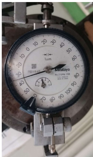
Figura 18: Relógio comparador com resolução de 0,001mm
