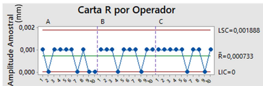
Figura 24: Carta de amplitude para a cota batimento da calota
