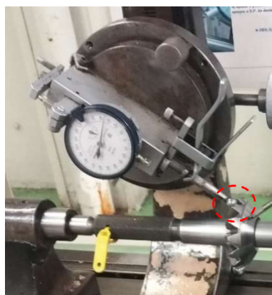
Figura 15: Método de medição do batimento do furo
