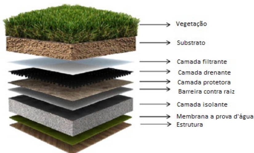
Figura 2 – Esquema das camadas de um telhado verde.
