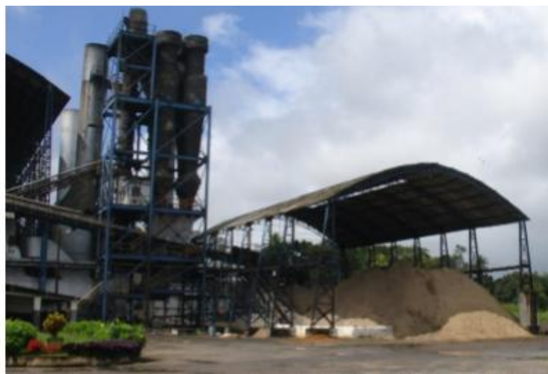
Figura 11 - Secador pneumático situado em Pernambuco
