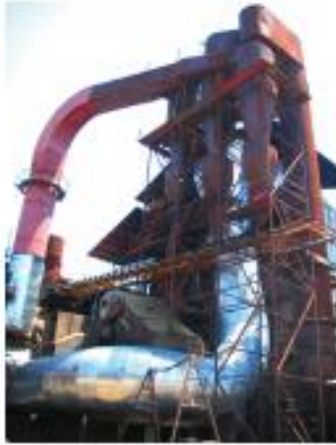
Figura 10- Secador pneumático da usina de Nuñoco(México)
