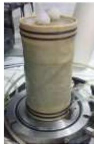
Espera-se o corpo de prova saturar e por um sistema de abertura de válvulas e controle de pressão pode-se controlar a carga hidráulica atuante no corpo de prova. Mede-se o tempo que um determinado volume do fluido leva para passar pelo corpo de prova, calculando a permeabilidade de maneira análoga ao método explicitado anteriormente.
