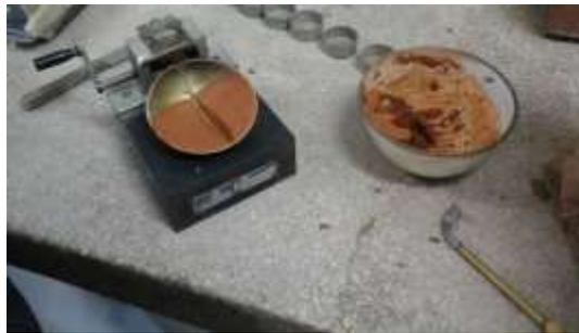
O objetivo do ensaio é verificar a umidade do solo para que a ranhura (talude) seja fechada após a aplicação de 25 ciclos no sistema. O solo é misturado com água procurando torná-lo homogêneo e sem bolhas. Para o primeiro ponto, o ideal é atingir uma consistência tal que sejam necessários cerca de 35 golpes para fechar a ranhura produzida pelo cinzel. Ao executar a ranhura, verificar se a altura do solo na parte central é de 10 mm ajustando com uma espátula se necessário.
