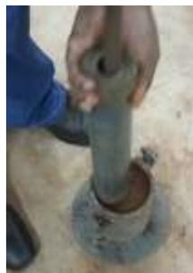
Realiza-se a pesagem do conjunto para a determinação do peso do solo úmido e faz-se a remoção do solo do molde cilíndrico com uso de um extrator, conforme a Figura 15, com coleta de amostra para caracterização da umidade. Conhecido o peso da amostra e o volume do cilindro é possível calcular a densidade do solo pela simples divisão entre eles.
