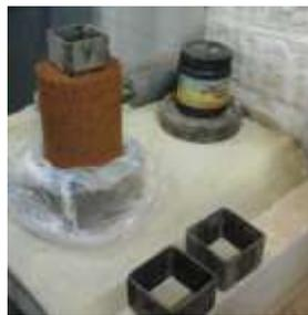
Figura 24 - Amostra indeformada a ser transferida para a caixa de cisalhamento direto.
