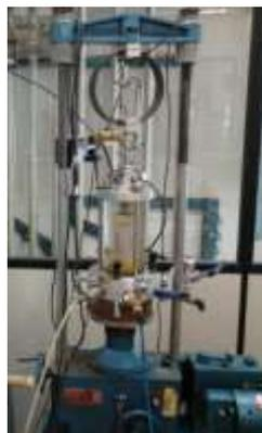
Como não existem tensões de cisalhamento nas bases e nas geratrizes do corpo de prova, os planos horizontais e verticais são os planos principais. Se o ensaio é de carregamento, o plano horizontal é o plano principal maior. No plano vertical, o plano principal menor, atua a pressão confinante. A tensão devida ao carregamento axial é denominada de tensão desviadora. Durante o carregamento, medem-se, a diversos intervalos
