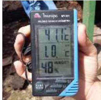
Figura 5 - Temperatura interna central da leira de compostagem.
