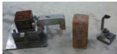
Figura 25 - Equipamento para realização do ensaio de cisalhamento direto.
