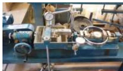
Aplica-se então uma tensão normal ao corpo de prova ao solo, iniciado também o deslocamento relativo entre as metades da caixa. O equipamento de ensaio, mostrado na Figura 25, é capaz de manter uma velocidade constante e com o uso de extensômetros e anel dinamométrico é possível realizar as leituras de deslocamento e resistência ao cisalhamento.
