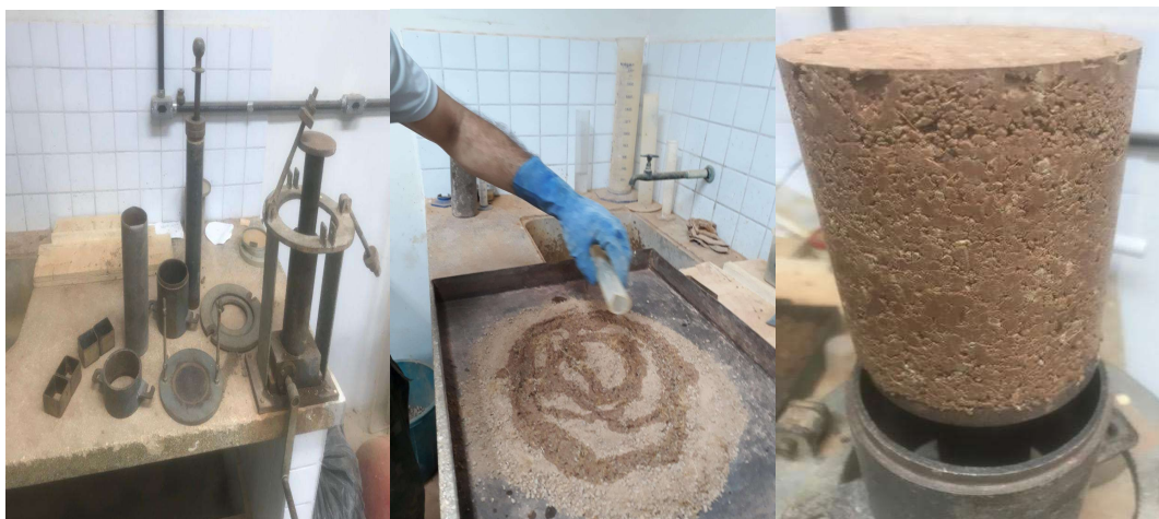
Figura 29 - Ensaio de Compactação de Solo e Misturas
