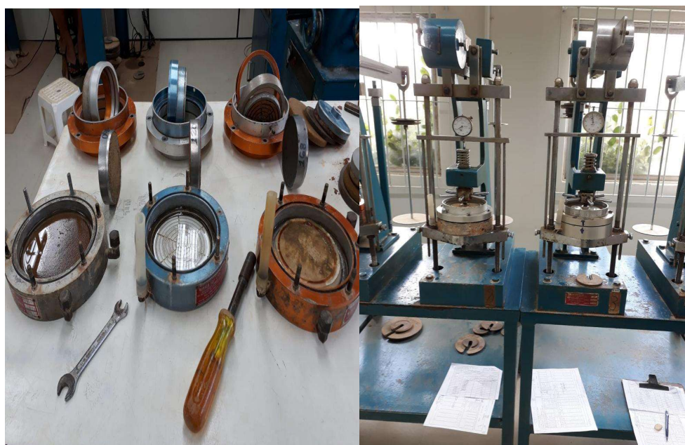
Figura 37 - Ensaio de Expansão “Livre”
