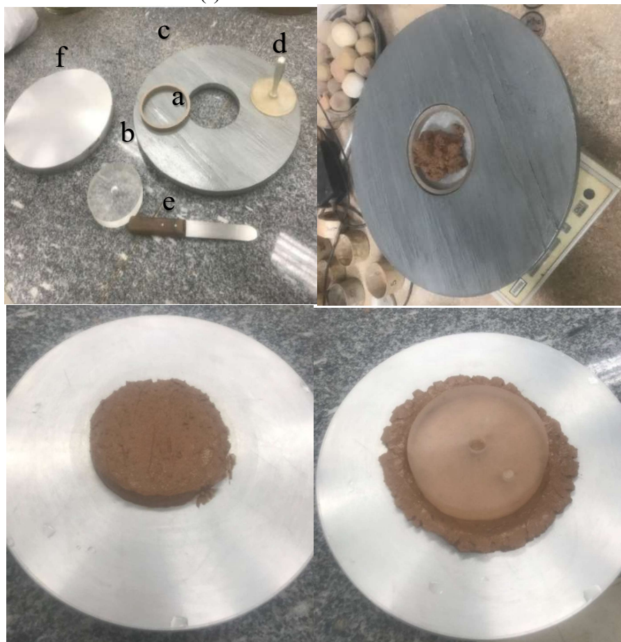
Figura 33 - Ferramentas utilizadas para moldagem de amostras do ensaio squeeze-flow a) Gabarito de madeira, (b) placa superior, (c) anel, (d) placa de suporte, (e) espátula e (f) Placa inferior de metal.
