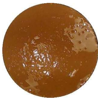
Figura 84 - Sequência da formação de fissuras da mistura solo+2% Fibra
