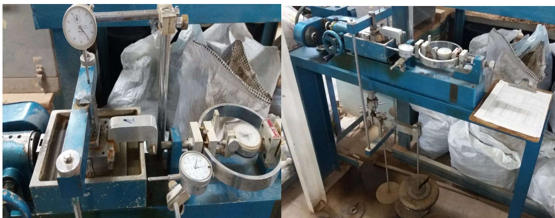
Figura 42 - Amostras para realização do ensaio de cisalhamento direto
