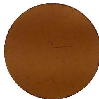
Figura 84 - Sequência da formação de fissuras da mistura solo+2% Fibra
