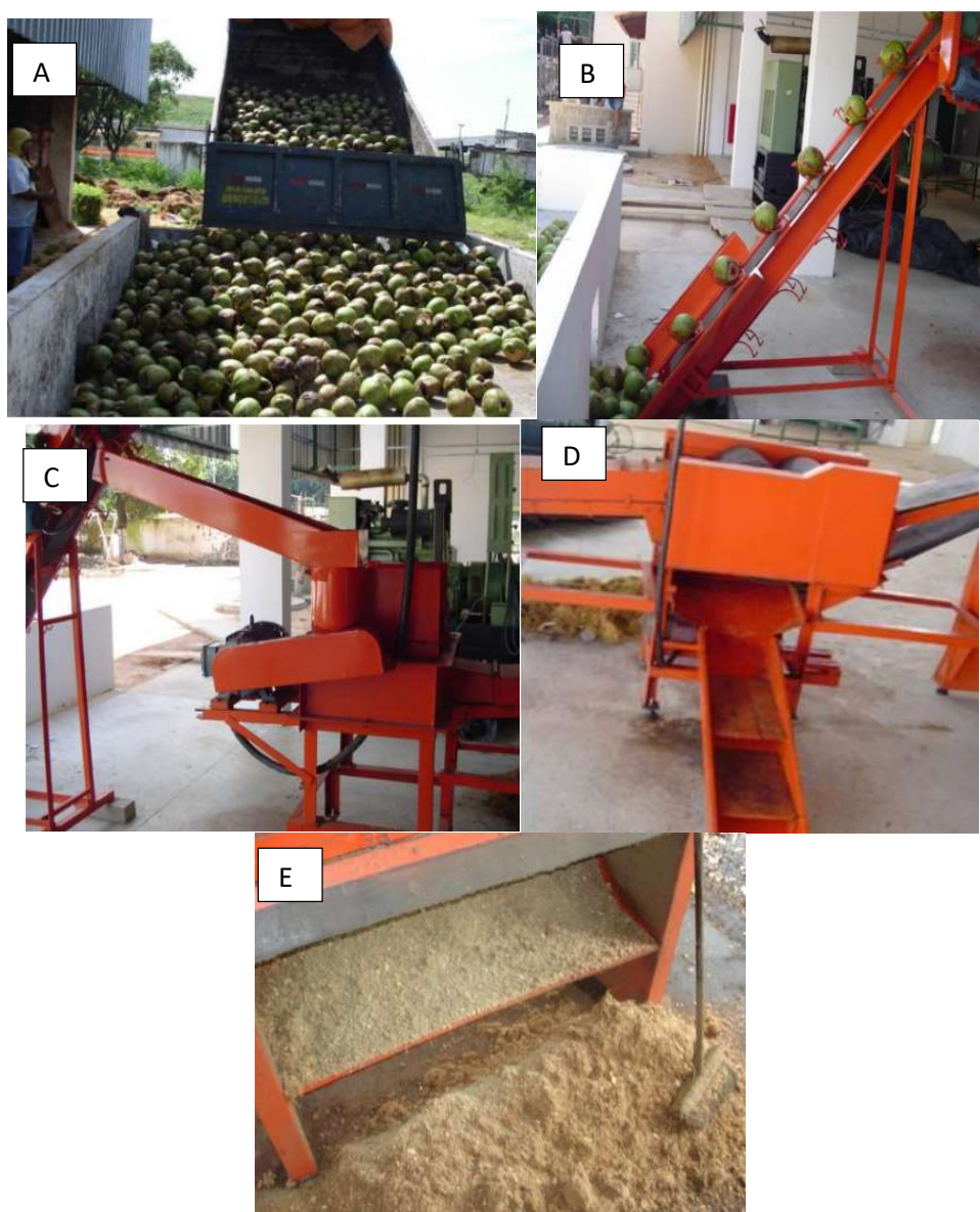
Figura 10 - Sequência de etapas para beneficiamento da casca do coco.
