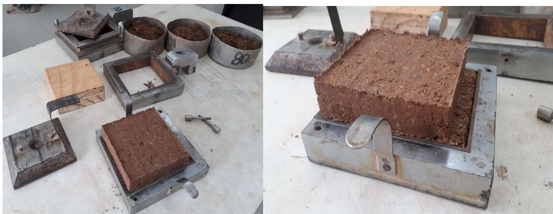
Figura 41 - Moldagem das amostras na caixa de cisalhamento direto
