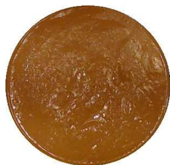
Figura 78 - Sequência da formação de fissuras da mistura solo+0,25% Fibra
