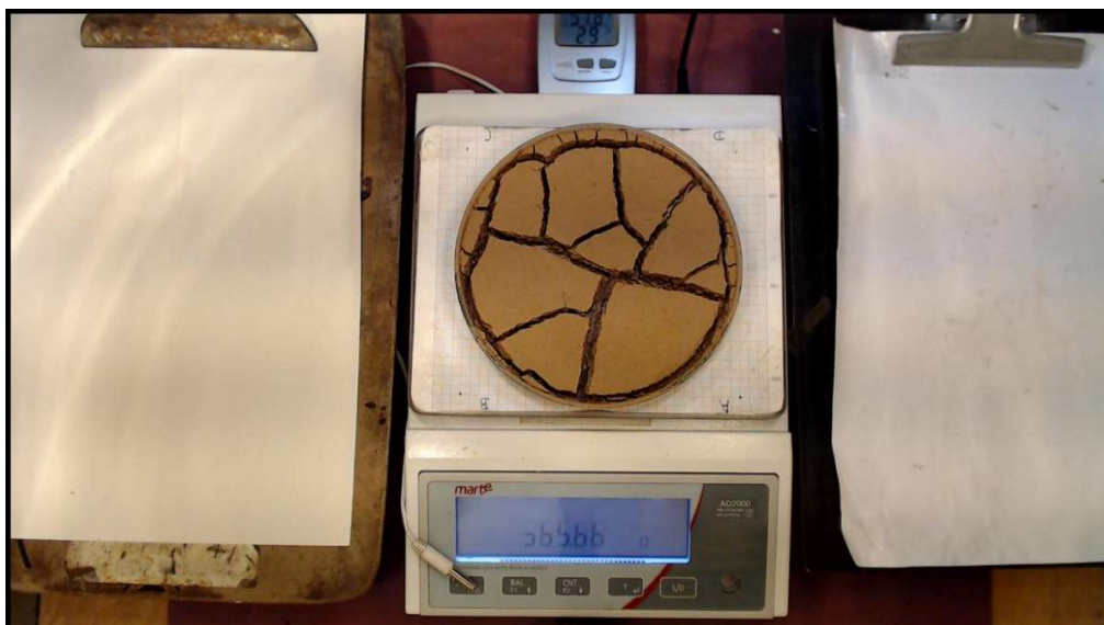
Figura 46 - Fim do ensaio de formação de fissuras para a amostra solo natural
