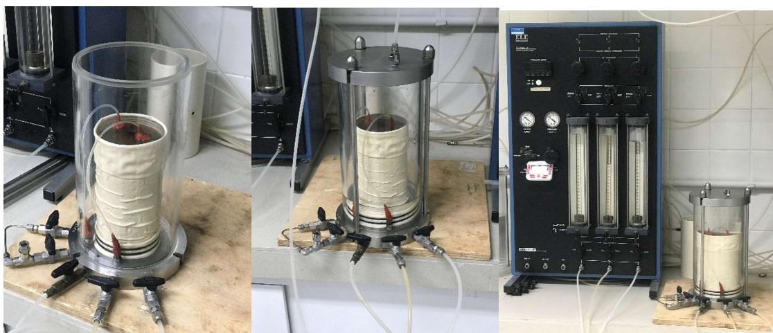
Figura 32 - Célula montada para realização do ensaio de condutividade hidráulica
