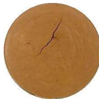
Figura 80 - Sequência da formação de fissuras da mistura solo+0,5% Fibra
