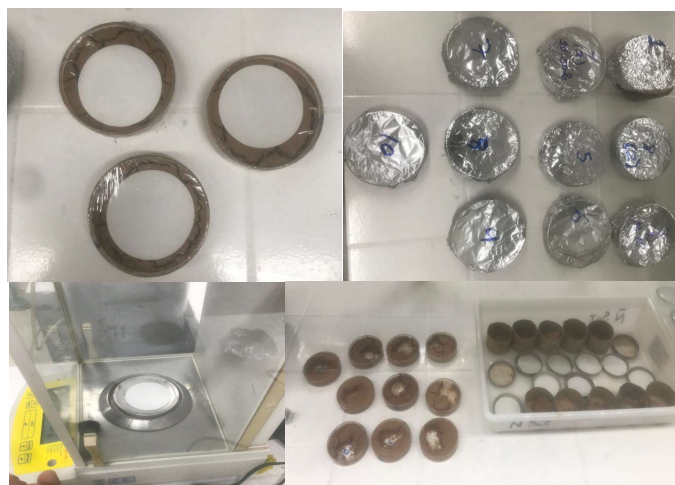
Figura 52 - Determinação da sucção das amostras
