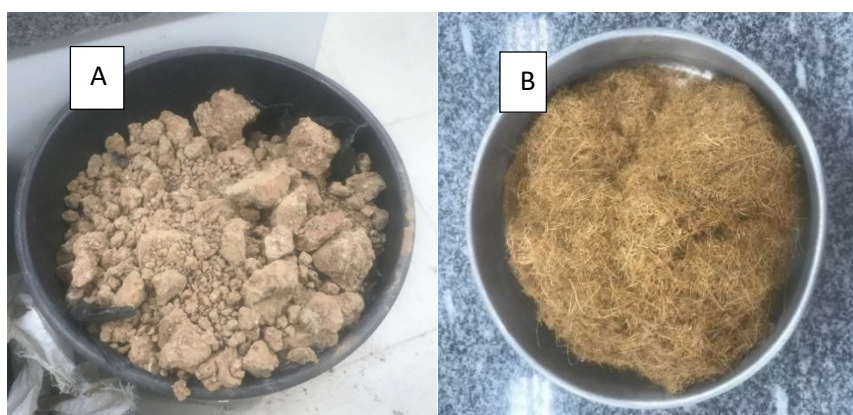
Figura 26 - Amostras dos materiais: a) Solo de Paulista/PE, b) Fibras de Coco
