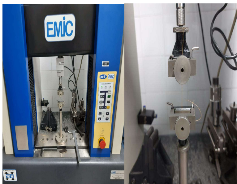
Figura 25 - Ensaio de tração direta nas fibras de coco
