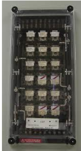
Figura 2 – Relé de bandeira ( flag relay ).
