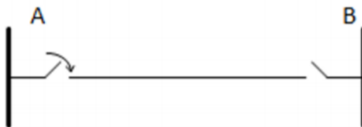
Figura 3 - Manobra para Energização de Linhas de Transmissão
