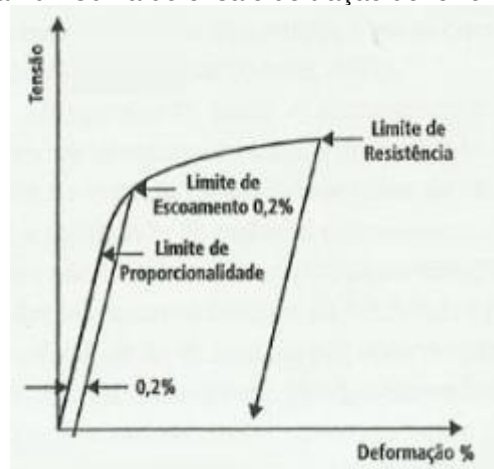
Figura 10 - Curva do ensaio de tração de ferro nodular ferrítico
