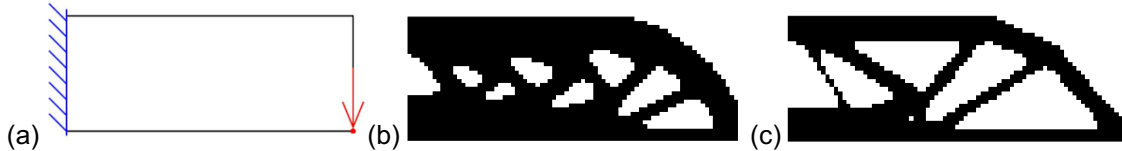
Figura 16 – Viga engastada otimizada pelo método BESO: (a) domínio, (b) f_v = 75\% e (c) f_v = 50\% .
