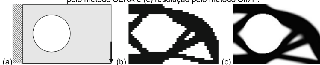
Figura 22 – Otimização da viga engastada 2D com região vazia prescrita: (a) domínio, (b) resolução pelo método SERA e (c) resolução pelo método SIMP.
