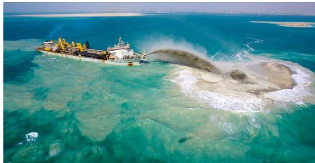
Figura 12 - Dragagem da ilha Palm Deira. A areia é pulverizada a uma velocidade de 10 m por segundo.
