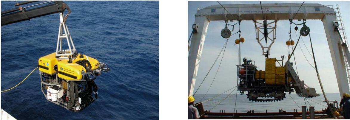
Figura 5 - Robôs submarinos usados para prospecção de minérios no fundo do mar.
