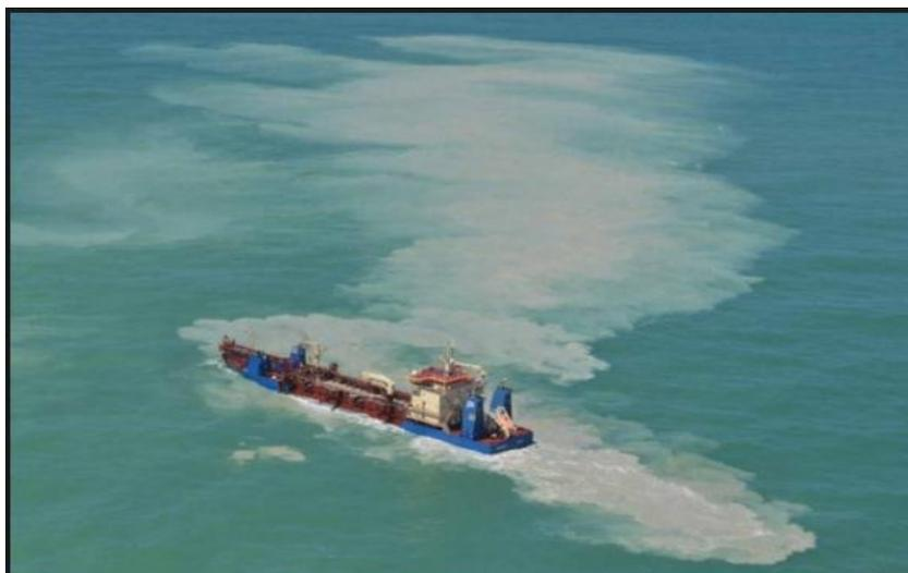
Figura 8 – Draga utilizada na engorda da praia
