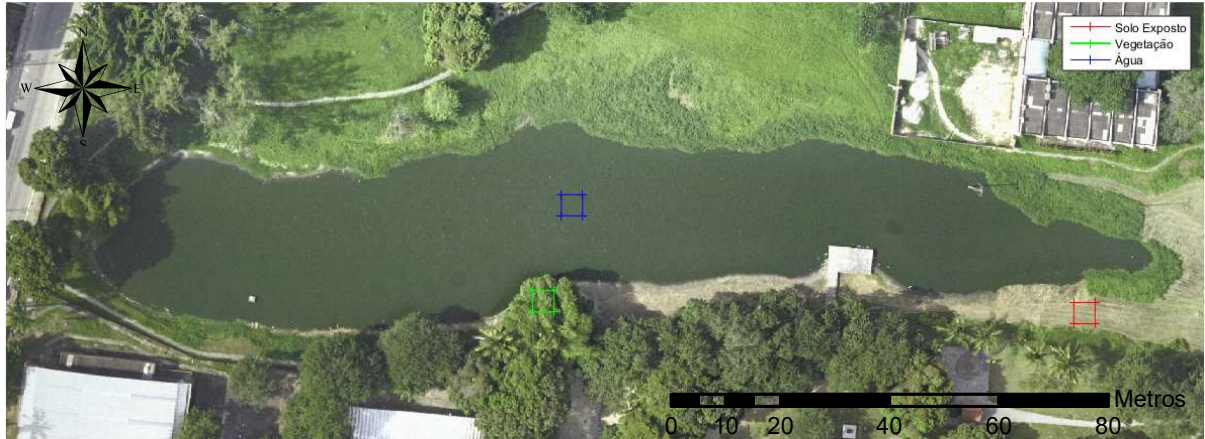
(a) Retângulo envolvente das amostras de solo exposto (em vermelho), vegetação (verde) e água (azul) sobrepostas na Ortofoto.
