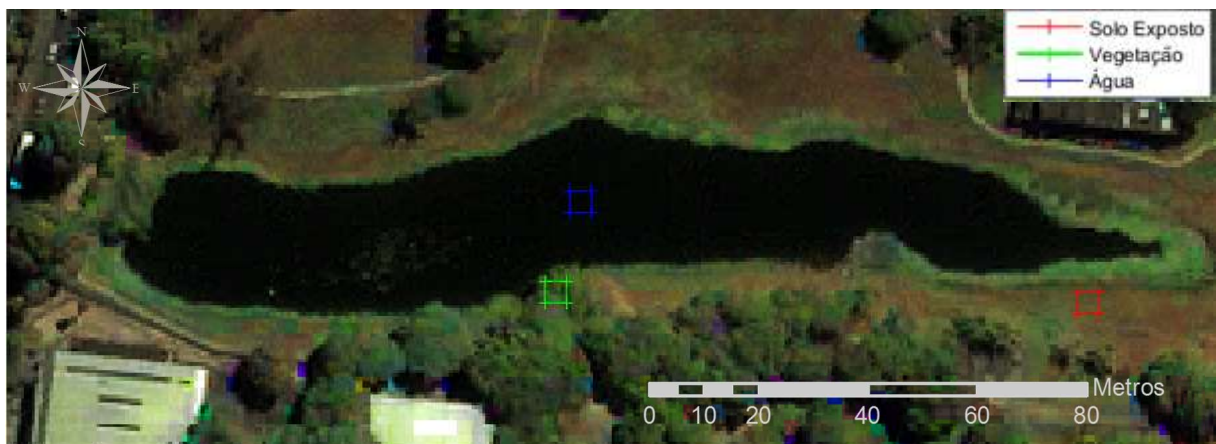
(a) Retângulo envolvente das amostras de solo exposto (em vermelho), vegetação (verde) e água (azul) sobrepostas na Imagem IKONOS-2 fusionada 321-RGB
