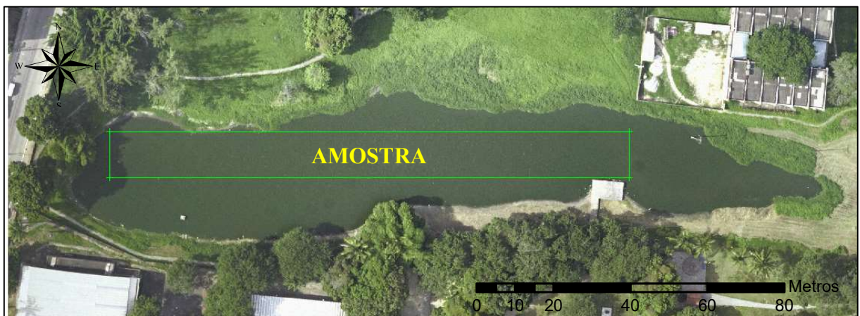
Figura 29 - Banda do Vermelho da Ortofoto e retângulo (em verde) escolhido como amostra para o método do paralelepípedo.
