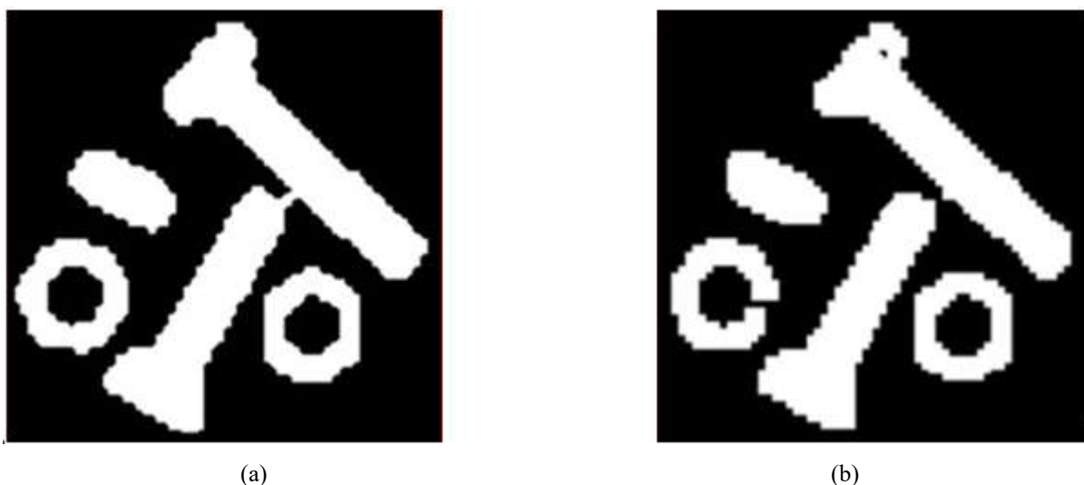
Figura 10 - (a) Imagem Original, (b) Imagem após aplicação do filtro de abertura.
