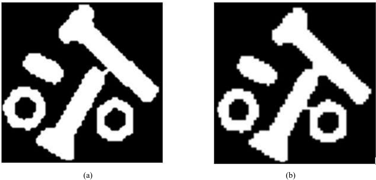
Figura 11 - (a) Imagem binária original, (b) Imagem binária após aplicação do filtro de fechamento.
