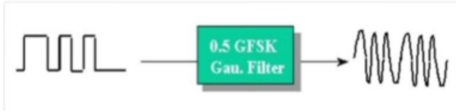
Figura 2.6: Funcionamento do filtro GFSK (Fonte: COMMUNICATIONS, 2022).
