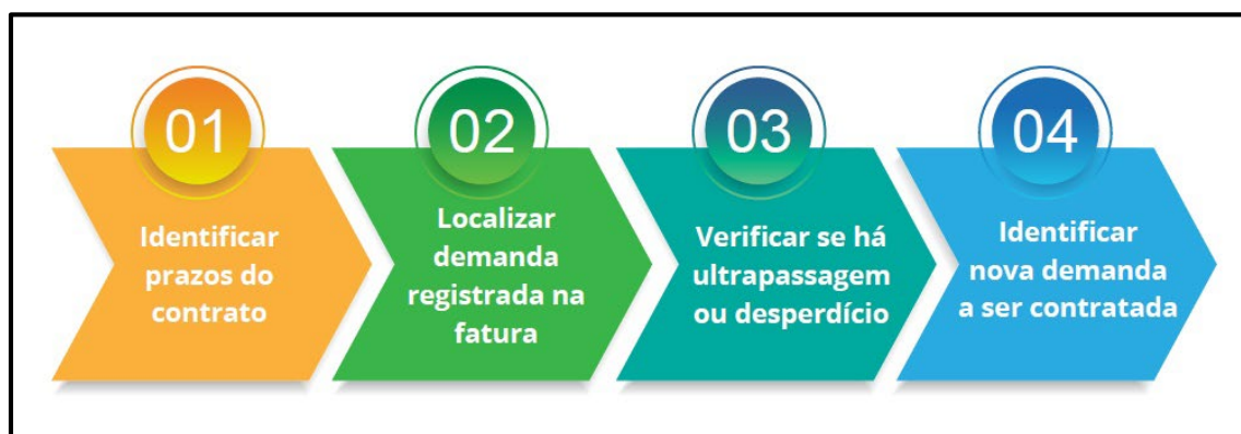
Figura 18 - Etapas para Adequação de Demanda Contratada.
