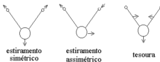
Figura 2. Representação esquemática dos três modos vibracionais fundamentais da molécula de água.
