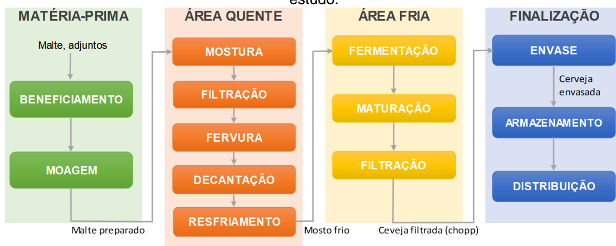
Figura 15: Fluxograma de blocos (BFD) do processo produtivo de cerveja na fábrica em estudo.
