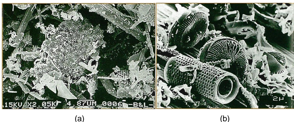
Figura 8: Microscopia eletrônica (1000x) da terra diatomácea (a) fina e (b) grossa.
