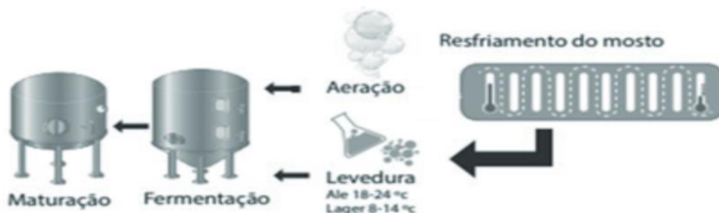
Figura 5: Etapas envolvidas nos processos de fermentação e maturação das cervejas.
