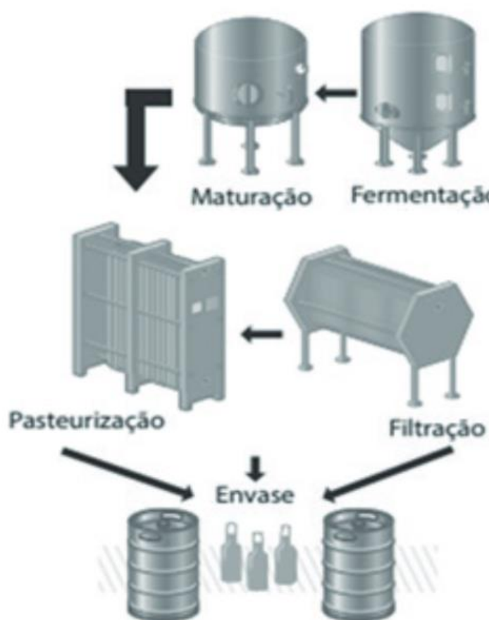
Figura 6: Etapas finais de produção da cerveja, com destaque para a filtração.
