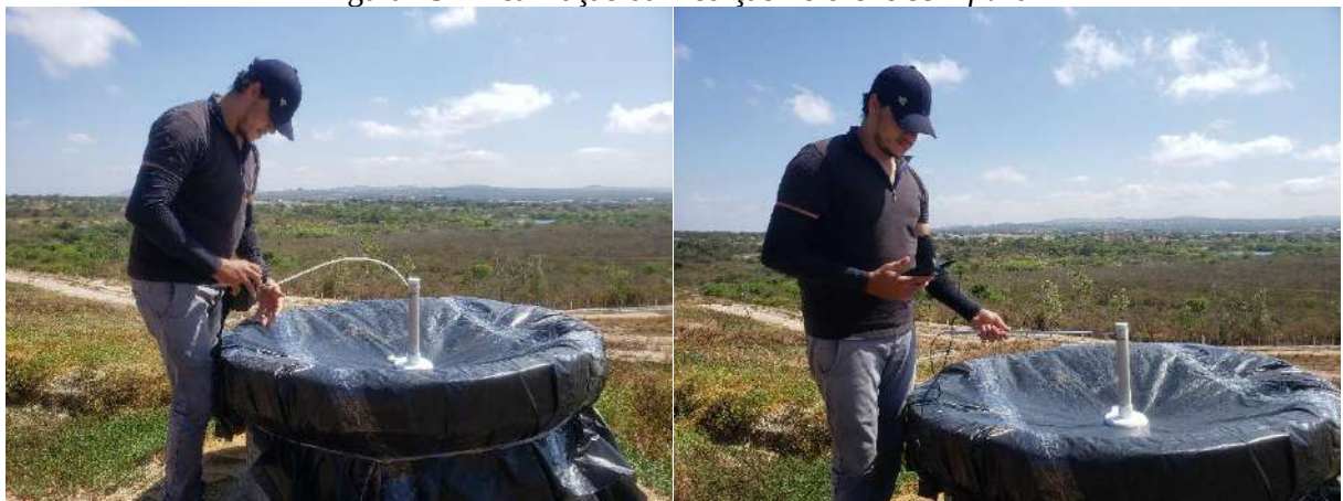
Figura 25 – Realização da medição no dreno sem flare
