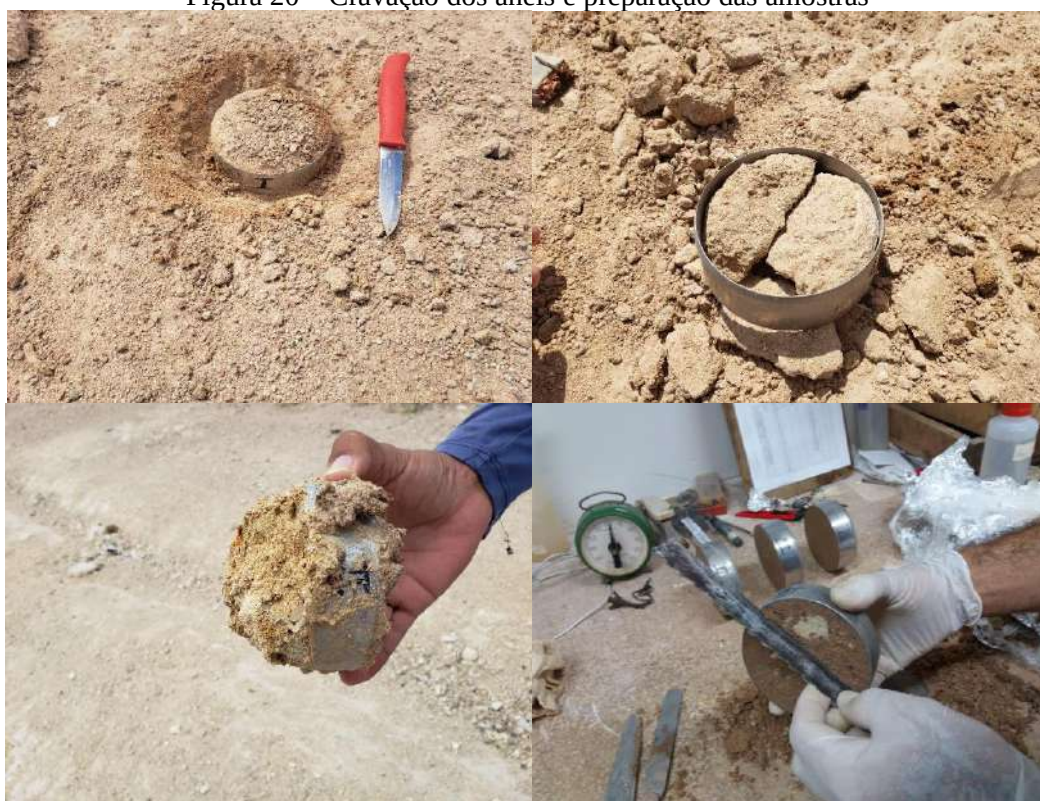
Figura 20 – Cravação dos anéis e preparação das amostras
