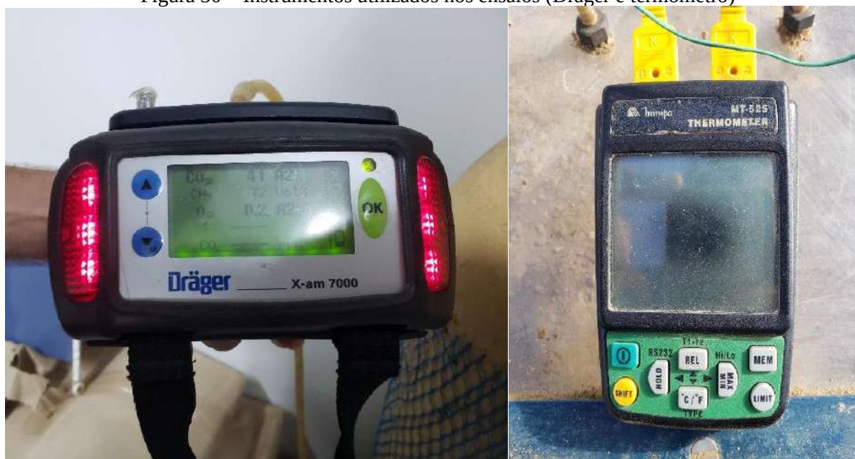
Figura 30 – Instrumentos utilizados nos ensaios (Dräger e termômetro)
