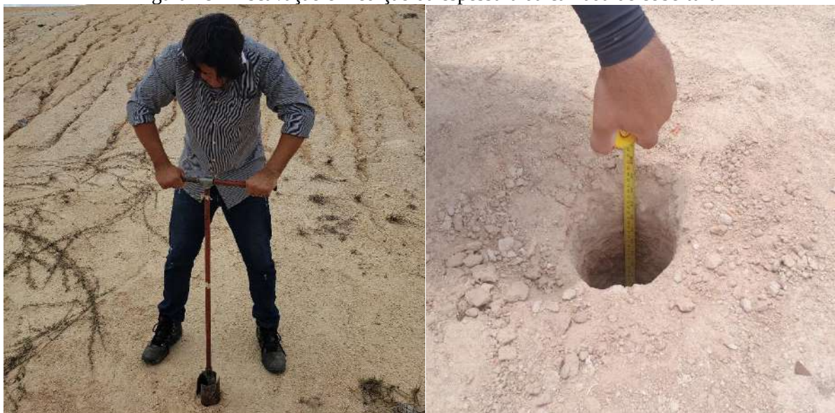
Figura 28 – Escavação e medição da espessura da camada de cobertura
