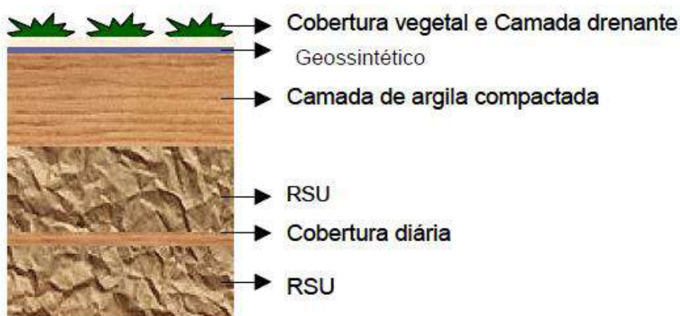
Figura 06 – Perfil das camadas de uma célula de RSU
