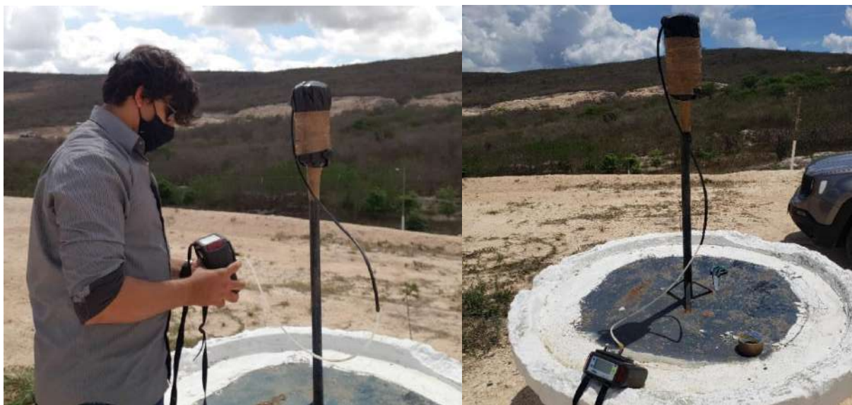
Figura 26 – Realização da medição no dreno com flare
