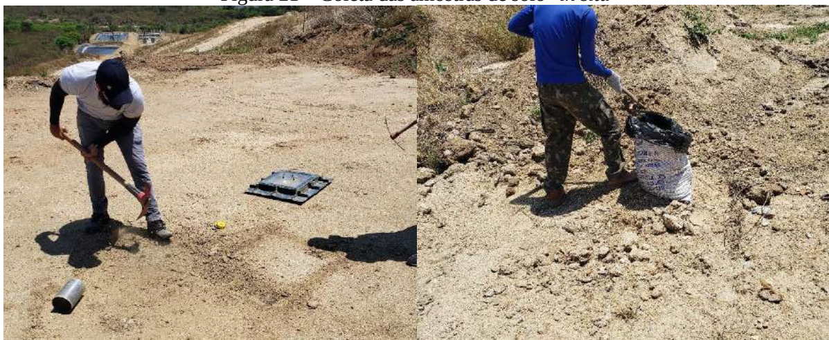
Figura 21 – Coleta das amostras de solo “ in situ ”
