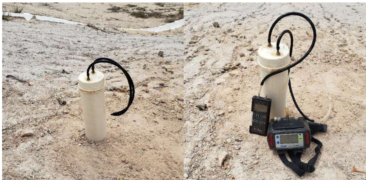
Figura 29 – Instalação do DMPC e medição das concentrações e da pressão
