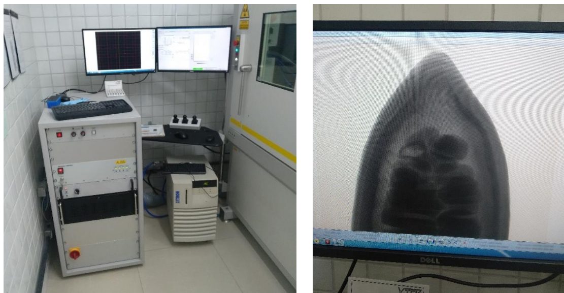
Figura 106 – (a) Equipamento e visualização do raio-X. (b) Escaneamento do cacau
