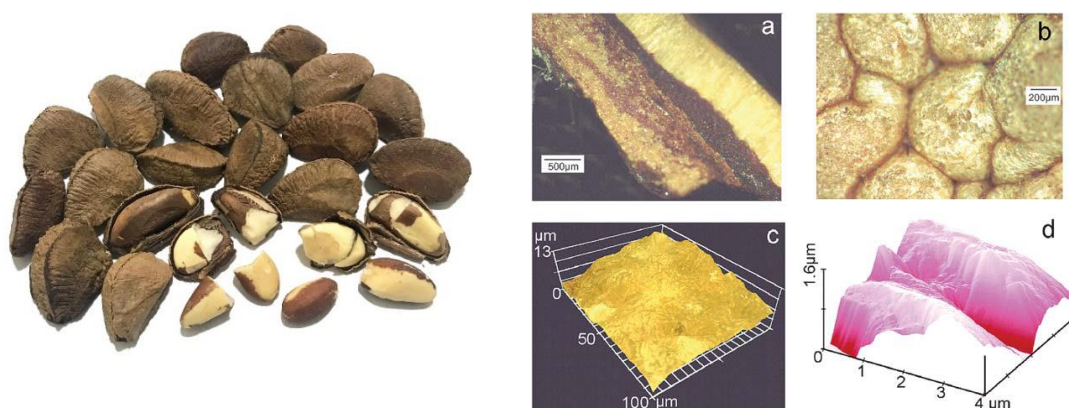
Figura 52 – Micrografias de uma casca dura da castanha (esq.): (a) superfície de fratura mostrando as camadas externa exibindo todas as fibras normais à superfície; (b) projeção da superfície 3D externa em baixa ampliação; (c) micrografia de superfície externa em perspectiva; e (d) AFM topografia de uma superfície externa com sítios de cume que requerem ponta de penetrador íngreme e afiada
