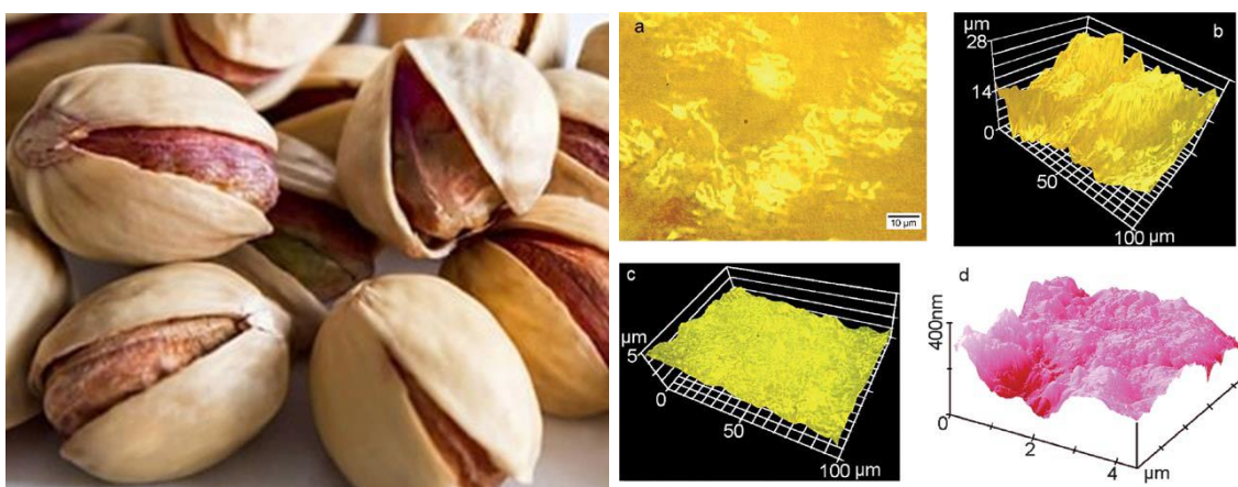
Figura 49 – (Esq.) Imagem do fruto pistácio. (a) projeção da superfície da fratura meridional mostrando células altamente estruturadas. (b) Micrografias de P. fandonchi ; (b) micrografia em perspectiva de uma superfície de fratura latitudinal; (c) micrografia
