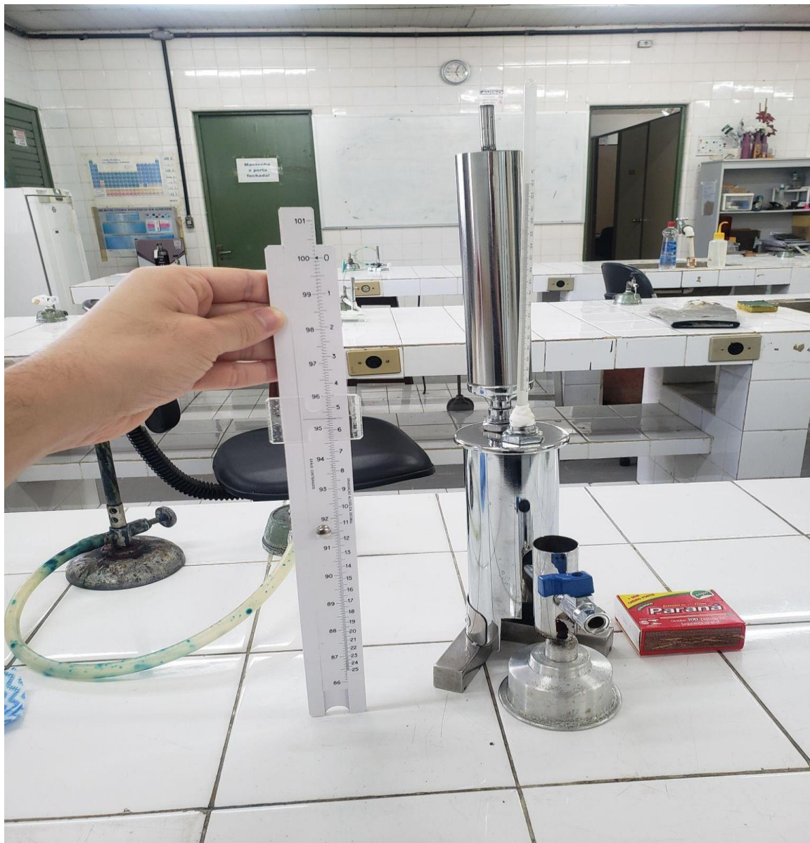
Figura 8 – Equipamento utilizado para determinar teor alcoólico, ebuliômetro, termômetro e régua
