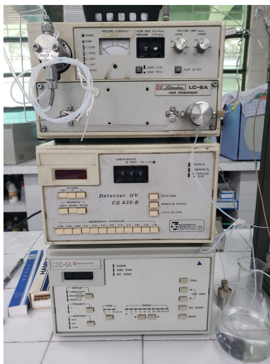
Figura 6: Sistema de equipamentos formado pelo CLAE e detectores UV e de condutividade.
