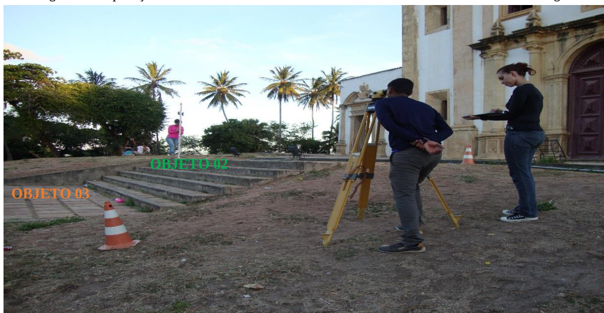
Figura 36 – Aplicação do Método de Nivelamento Geométrico Usando Nível Automático Analógico
