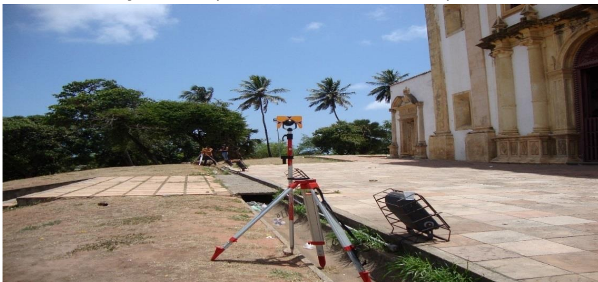
Figura 26 – Definição dos Vértices IC1 e IC2 Usando Interseção a Ré
