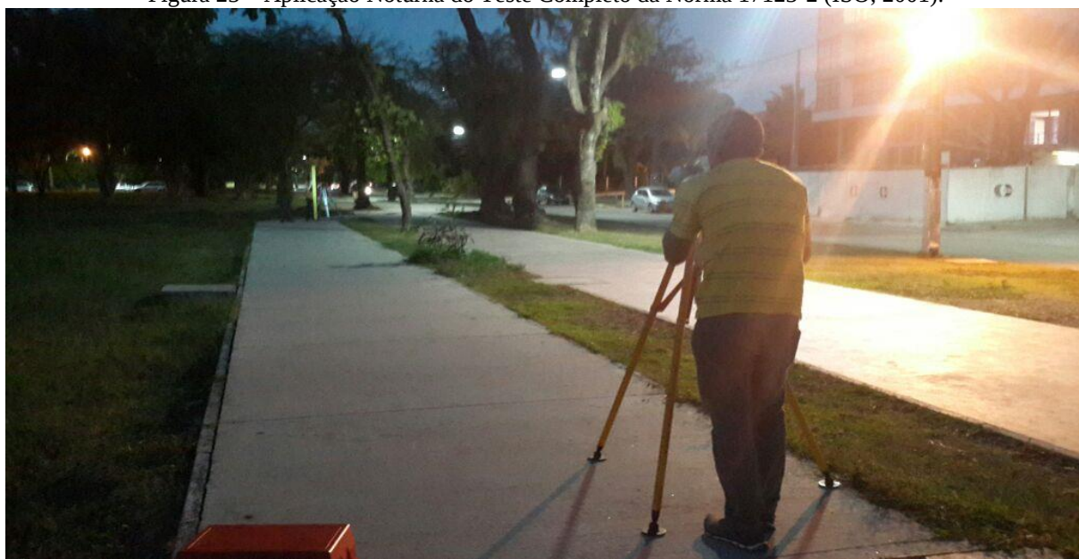
Figura 23 – Aplicação Noturna do Teste Completo da Norma 17123-2 (ISO, 2001).
