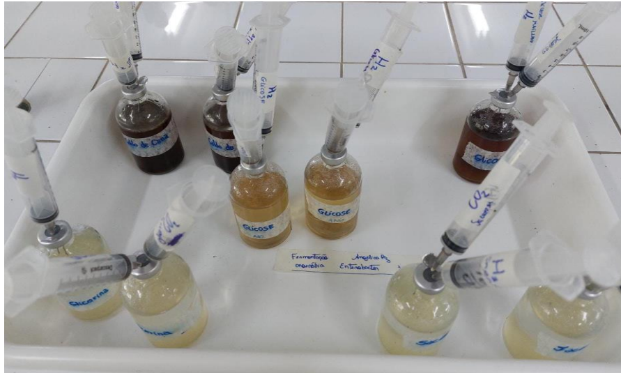
Figura 10. Seringas acopladas nos reatores durante o processo fermentativo para captação do gás.
