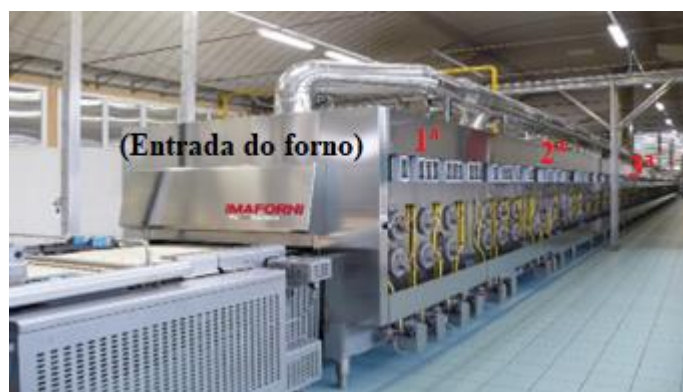
Figura 4 – Representação das zonas do forno, sendo: 1ª parte, 2ª parte e 3ª parte.
