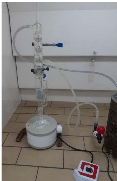
Figura 4 - Lavagem com acetona no extrator SOXHLET.
