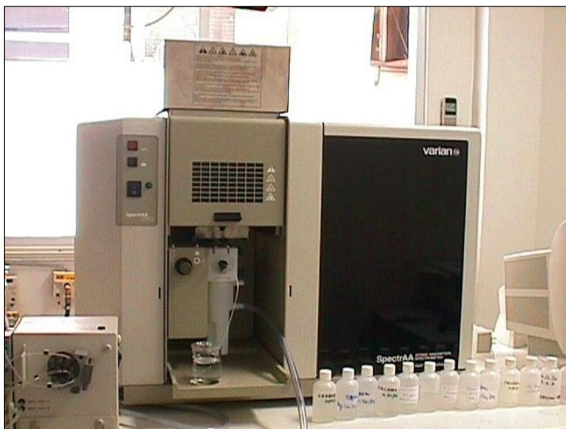
**Foto 16:** Espectrômetro de Absorção Atômica
