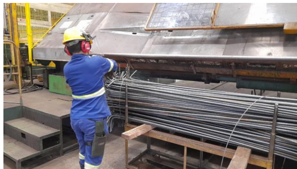
Figura 19 – Amarração do vergalhão após produzido
