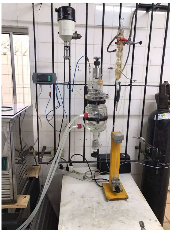
Figura 11 - Sistema utilizado para as reações de oxidação do glicerol
