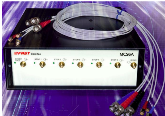
Figura 46 – Placa de fotocontagem (modelo MCS6A da empresa FAST ComTec), onde as entradas são: start (pulso do Arduino), stop 1 (detetor 1a), stop 2 (detetor 1b), stop 3 (detetor 2a) e stop 4 (detetor 2b).
