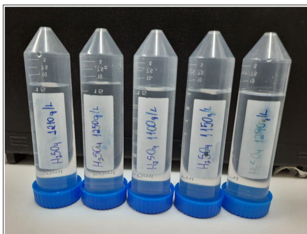
Figura 37 – Imagem das amostras de eletrólito a serem depositadas sobre a fibra monomodo, conforme ilustrado na Figura 34.
