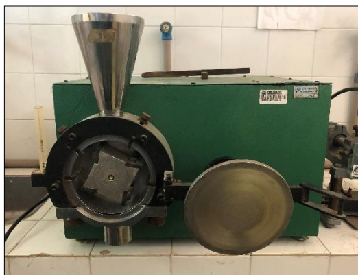
Figura 5 – Moinho de facas utilizado para produção da farinha das cascas dos maracujás.
