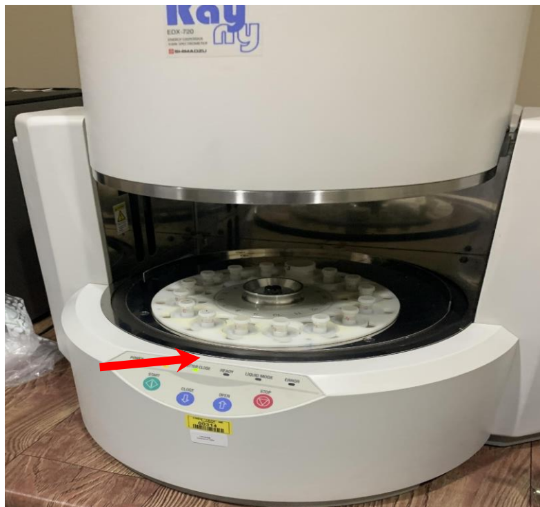
Figura 8 – Espectrômetro de fluorescência de raios-X por energia dispersiva EDX-720, com as amostras alocadas no carrossel, indicado pela seta.
