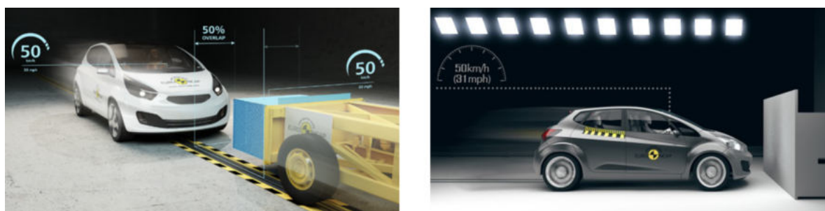
Figura 25 – Ensaios de Impacto Frontal, Contra Parede Deformável à Esquerda e Contra Parede Rígida à Direita.
