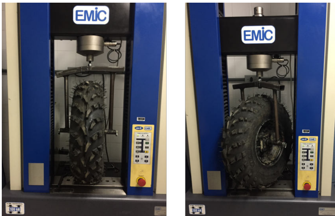
Figura 43 – Testes Experimentais de Compressão Realizados na UFPE.
