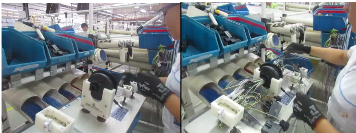
Figura 38 - Passagem de circuitos pelo grommet na pré-montagem
