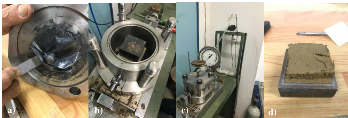
Figura 112 – Etapas de realização do ensaio de cisalhamento direto com sucção controlada. a) colocação de graxa; b) preparo da amostra dentro da célula; c) prensa com ensaio funcionando; d) corpo de prova após rompido.
