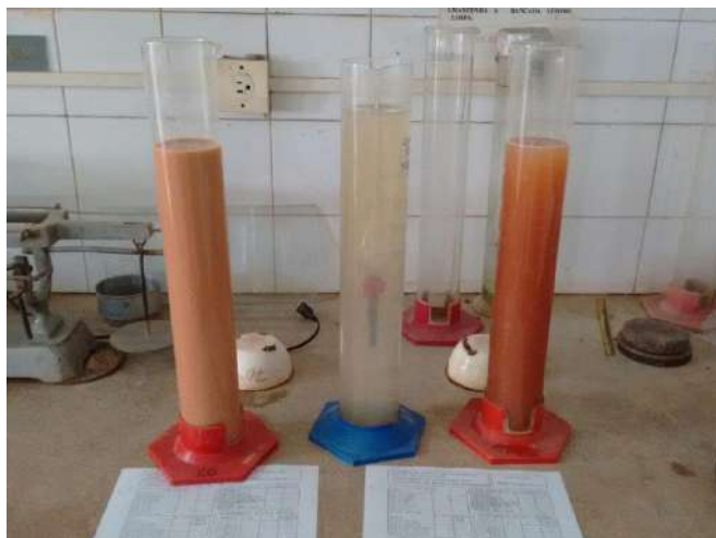
Figura 88 – Realização do ensaio de sedimentação com adição de defloculante nas amostras dos blocos.
