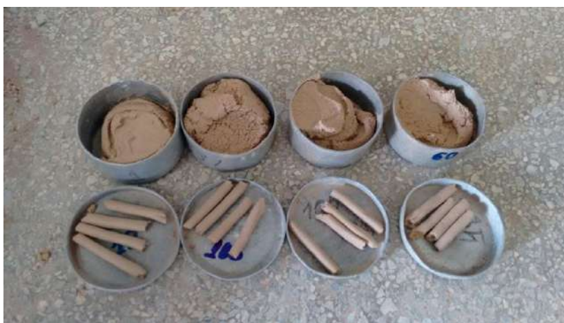
Figura 89 – Realização dos ensaios de LL e LP nas amostras dos blocos.
