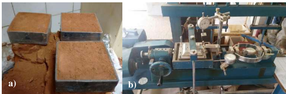
Figura 110 – Etapas de realização do ensaio de cisalhamento direto: a) moldagem do corpo de prova; b) realização do ensaio na prensa de cisalhamento.
