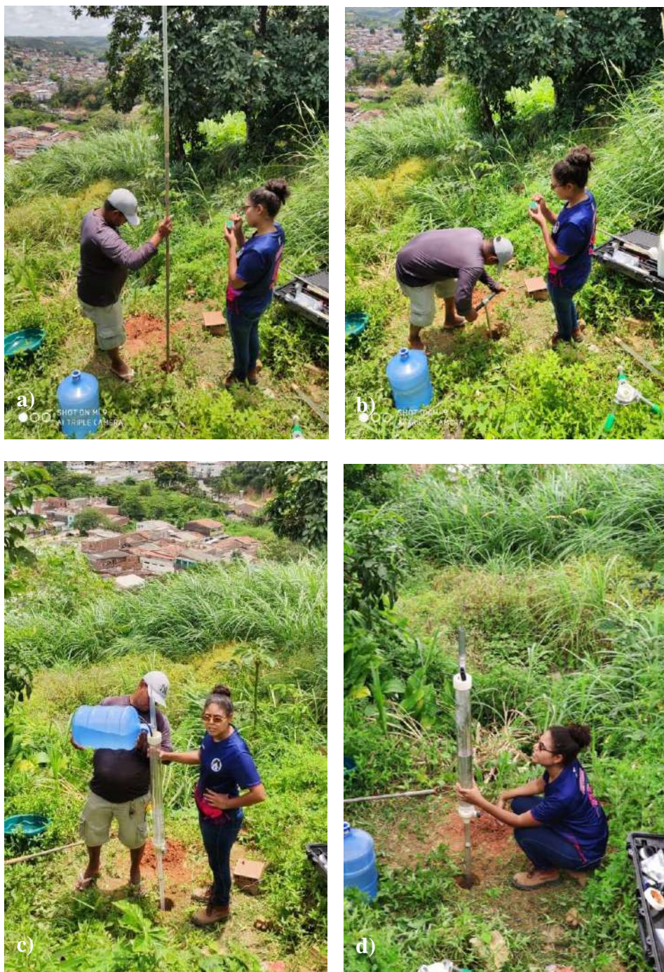
Figura 71 – Procedimento de instalação e realização do ensaio com o permeâmetro de Guelph: a) Inserido trado no solo; b) realização do furo com o trado; c) instalação do equipamento, d) realização das leituras durante o ensaio.
