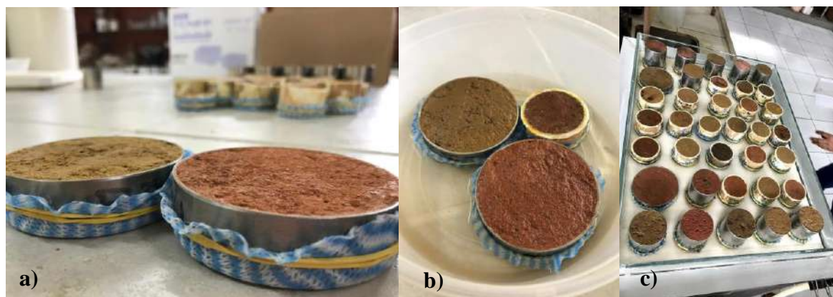
Figura 105 – Etapas do ensaio para determinação da sucção por meio da mesa de tensão: a) preparação da amostra com telas de náilon e elástico; b) processo de saturação do solo por capilaridade; c) Realização do ensaio com mesa de tensão coberta.
