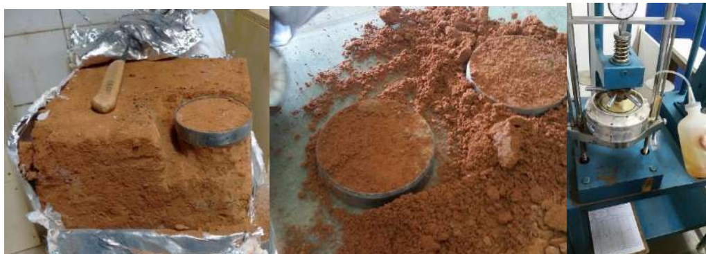
Figura 100 – Etapas de Realização do ensaio edométrico. a) e b) Moldagem do corpo de prova; c) Prensa com corpo de prova inundado.
