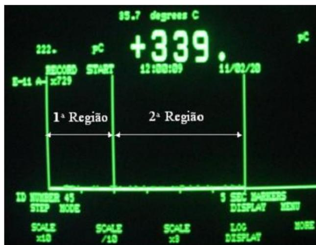
Figura 3.11 - Leitura TL característica para um disco produzido com 100% de Teflon (dose-teste: 50 mGy).
