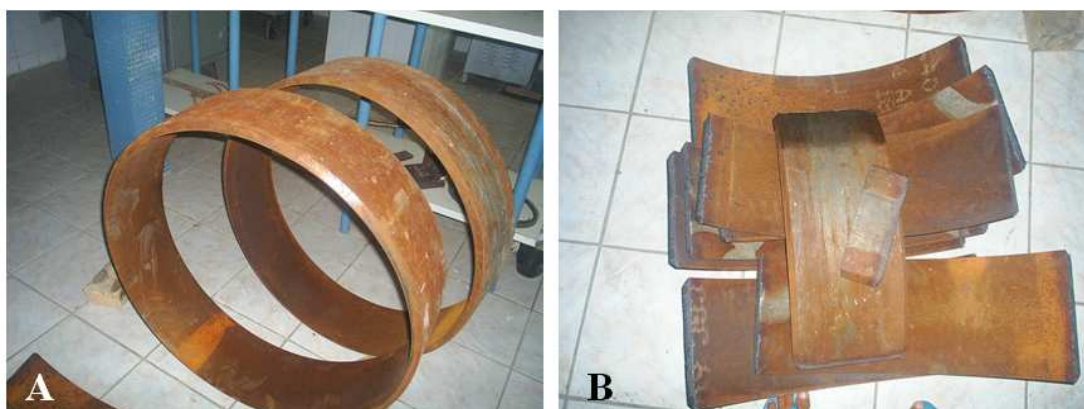
Figura 3.1 – Metal base: A) Anéis tubulares API 5L Grau X-80; B) Fatias a partir dos anéis tubulares cortados pelo processo oxi-corte
