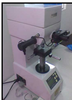
Figura 3.7 - Microdurômetro utilizado no ensaio de microdureza, modelo HVS-5, IMPORTÉCNICA
