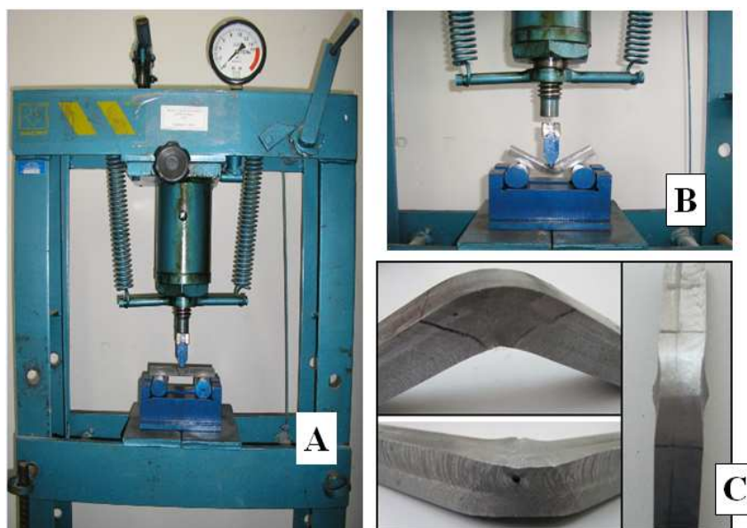
Figura 3.8 – Ensaio de dobramento; A) Vista Geral da prensa usada; B) Ensaio de dobramento; C) Vistas panorâmicas da área soldada dobrada.
