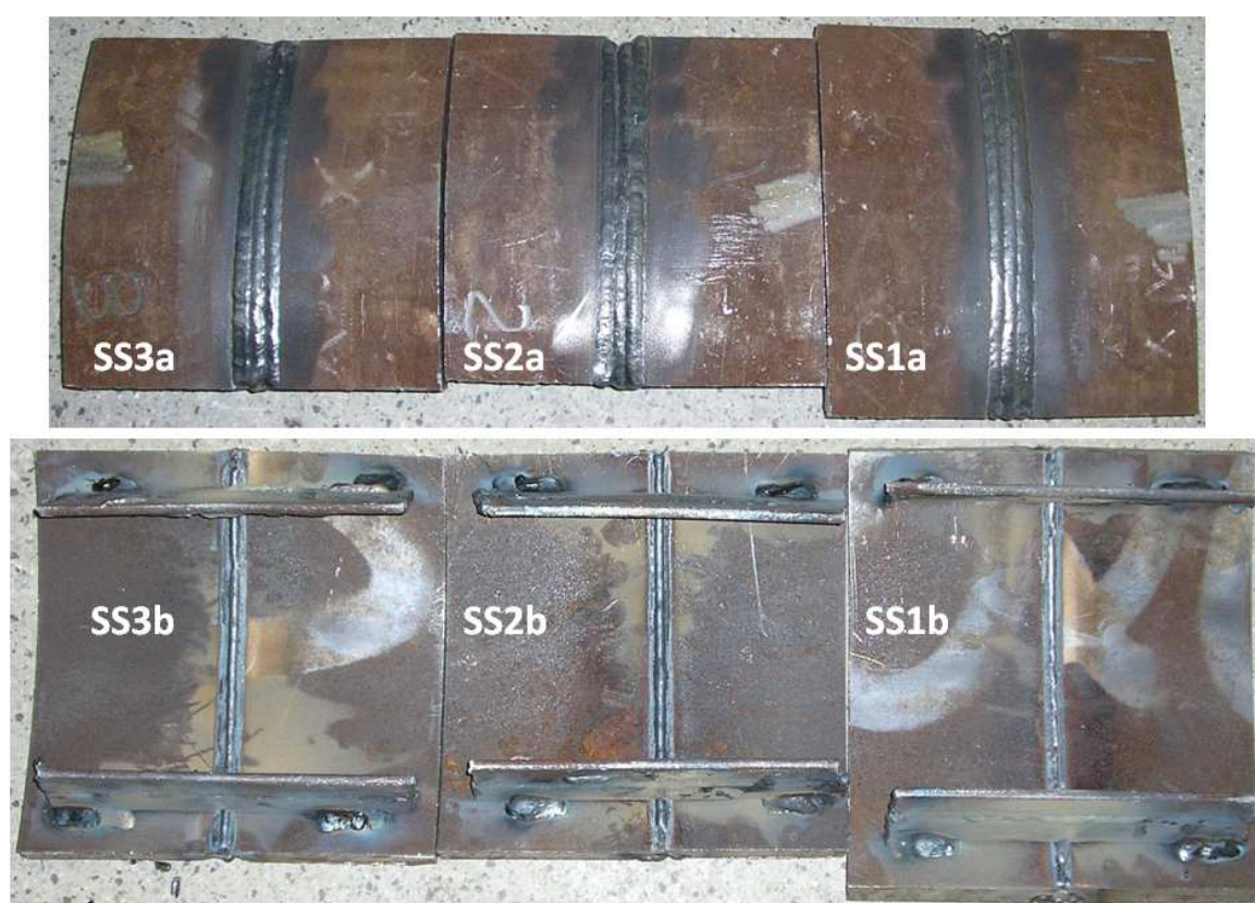
Figura 4.1 – Chapas de testes soldadas. (a) Vista da face; (b) Vista da raiz.
