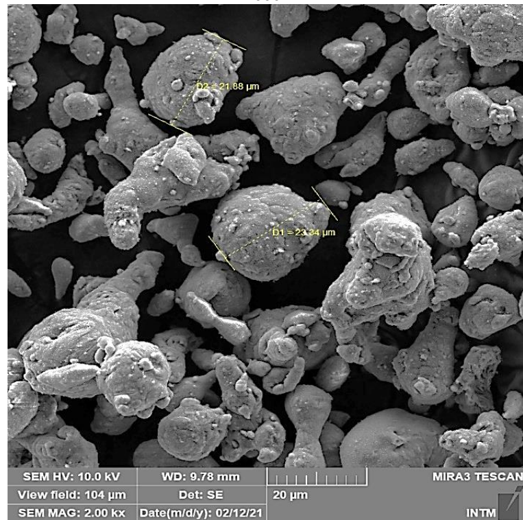
Figura 30 - Medição do tamanho da partícula do alumínio AA1100 conforme recebido – MEV Aumento de 2000x
