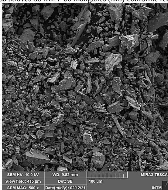
Figura 39 - Imagem obtida através do MEV do manganês (Mn) conforme recebido – Aumento de 500x
