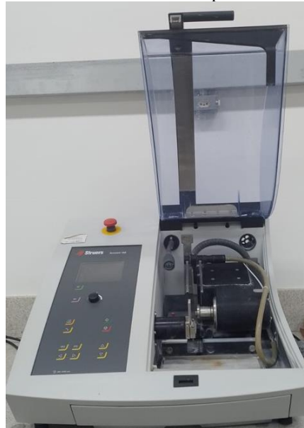
Figura 23 - Máquina automática de corte de precisão Struers Accutom-100
