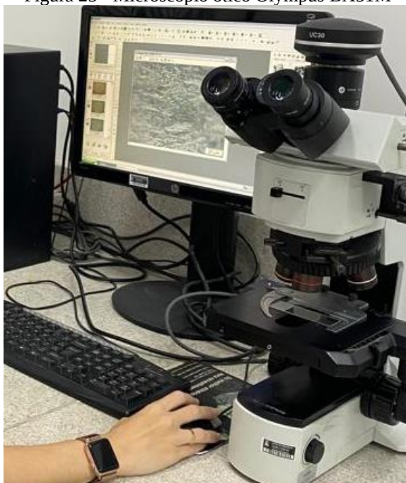
Figura 25 - Microscópio ótico Olympus BX51M
