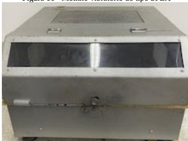
Figura 16 - Moinho vibratório do tipo SPEX
