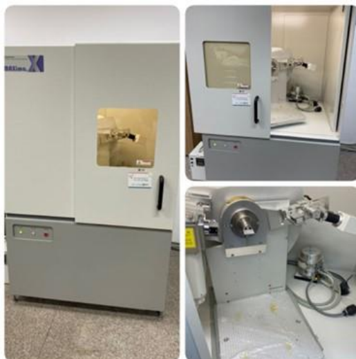
Figura 19 - Difratômetro Shimadzu, XRD-700
