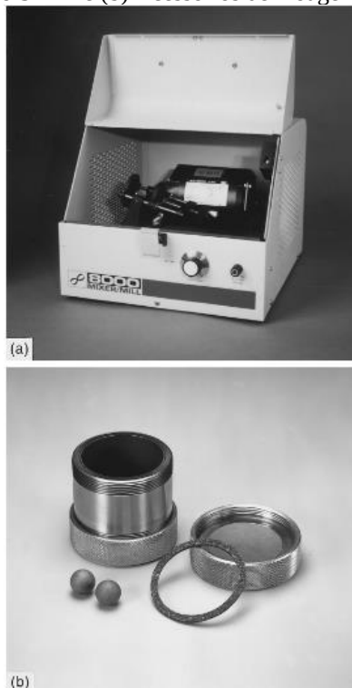
Figura 12 - (a) Moinho de bolas do tipo SPEX e (b) Acessórios de moagem: jarra tampa hermética e bolas
