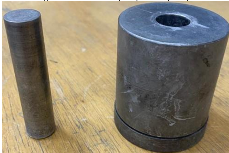
Figura 21 - Matriz de compactação de simples ação
