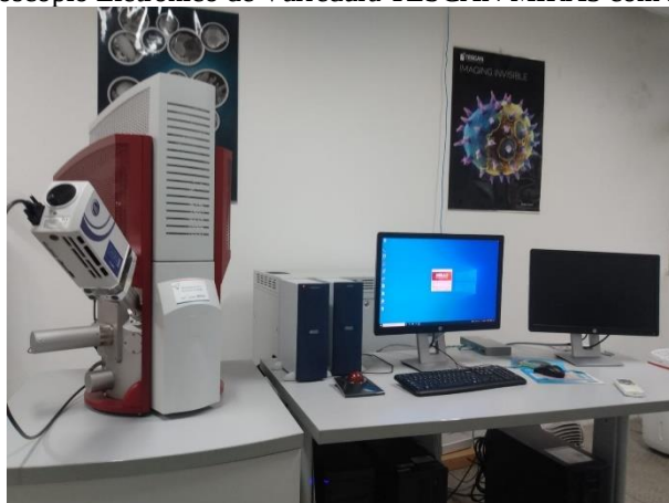
Figura 26 - Microscópio Eletrônico de Varredura TESCAN MIRA3 com EDS Oxford 15kv
