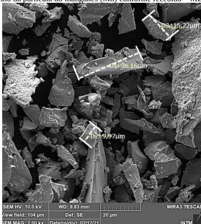
Figura 41 - Medição do tamanho da partícula do manganês (Mn) conforme recebido – MEV Aumento de 2000x
