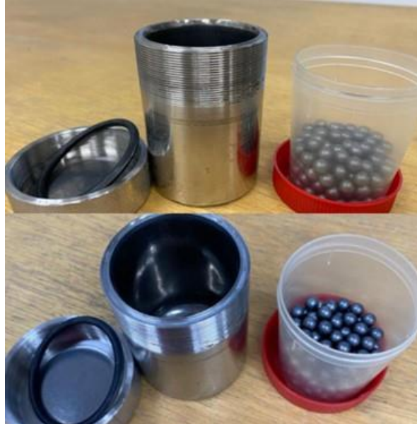
Figura 18 - Recipiente de moagem e esferas (corpos moedores)
