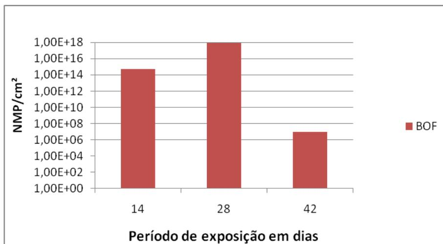
**Figura 4.2-** Quantificação de BOF na superfície do cupom de aço carbono AISI 1010
