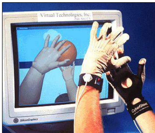
Figura 9 — Exemplo de luva usada para relatar a posição da mão e dos dedos de um usuário para um computador
