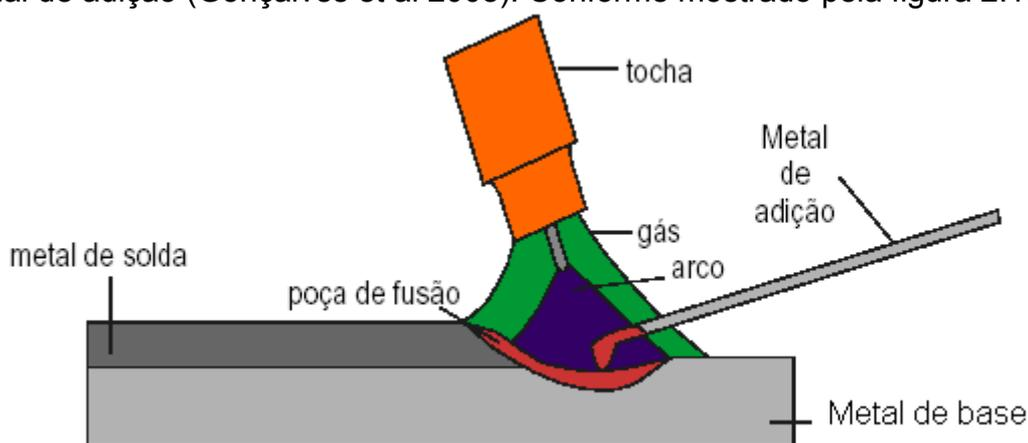
Figura 2.1 - Figura esquemática do processo TIG (Fonseca, 2004).
