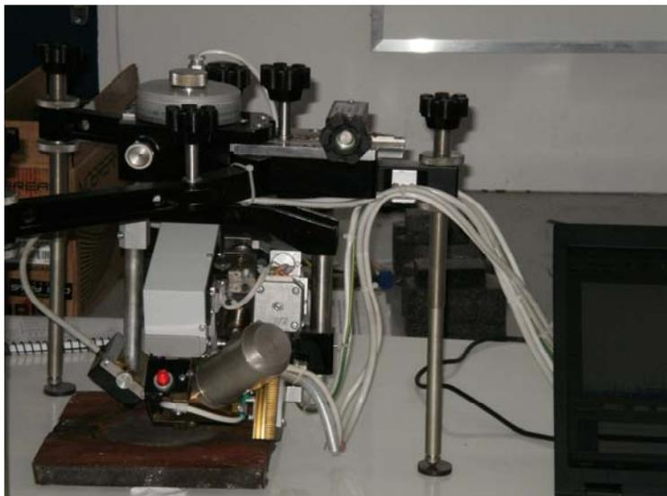
Figura 3.9 – Difratorômetro portátil de Raios-X
