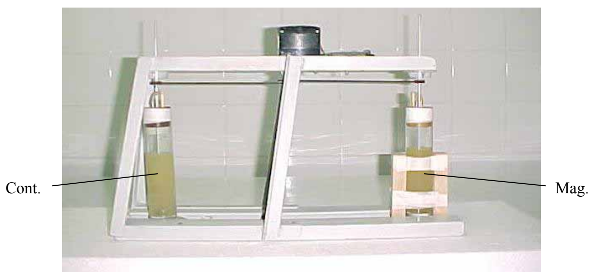
Figura 2 - Experimentos em biorreatores, dotados de agitação mecânica
